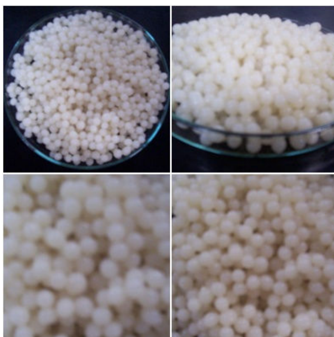
Figura 4.1- Pellets com Saccharomyces cerevisiae imobilizada em alginato de sódio a 3%
