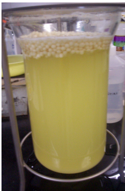
Figura 4.3: Fermentação do processo Batelada convencional interrompido devido a flutuação dos pellets.
