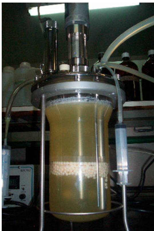
Figura 3.6: Foto do reator final utilizado nas fermentações.
