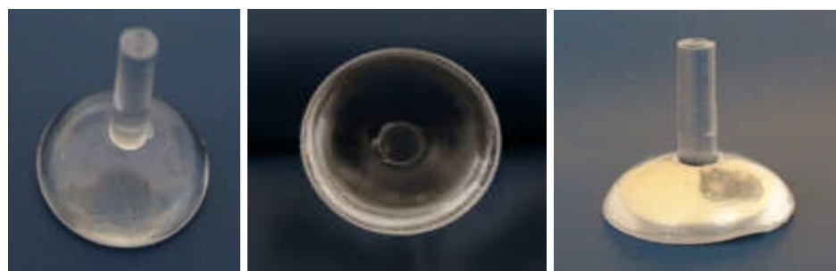
Figura 4 - Calota de íris transparente com pino utilizada como corpo-de-prova
