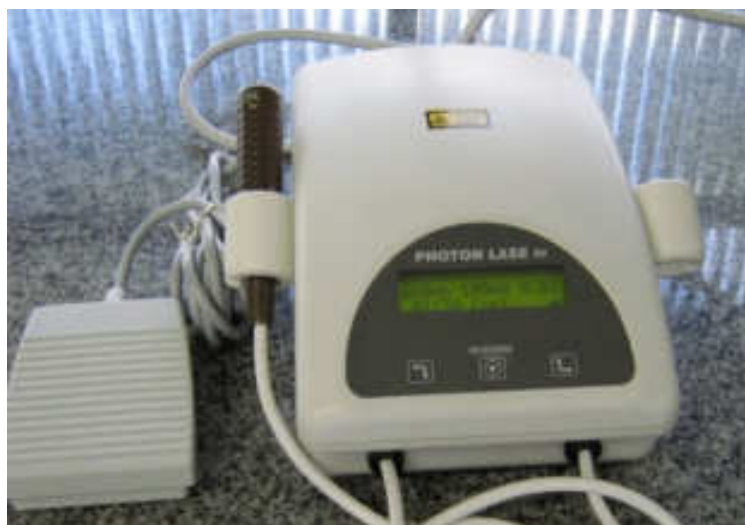
Figura 2 - Laser de Arseneto de Gálio Alumínio (PhotonLase III, DMC, São Carlos, Brasil).
