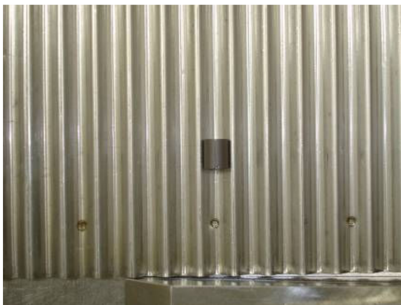
Figura 15 – Bandeja de transporte com uma pastilha de urânio “OLIVEIRA (2010)”.
