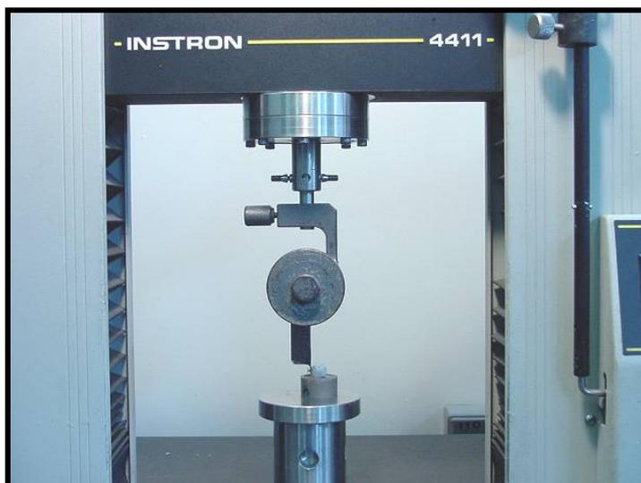
Figura 9 - Máquina de ensaio universal Instron (modelo 4411), com o corpo-de-prova posicionado para o ensaio de resistência ao cisalhamento.
