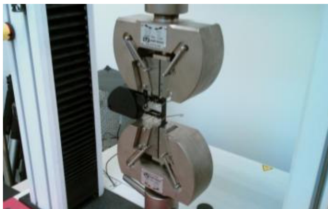
Figura 54 - Imagem do teste de tração realizado no Lab. do GMSIE.
