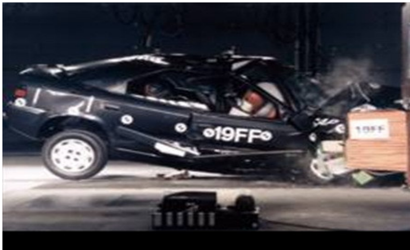
Figura 1 - Impacto frontal a 64 km/h contra barreira deformável com 40% de sobreposição – Veículo 1997 (EuroNCAP, 2009)
