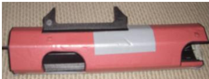
Figura 51 - Reforço pré-moldado que será submetido a ensaios de impacto.
