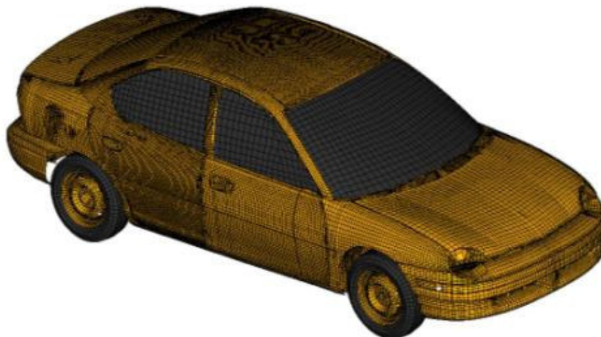
Figura 13 – Modelo em elementos finitos do veículo que será estudado (NCAC, 2009).
