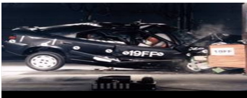
Figura 50 - Veículo com grande deformação na coluna A.
