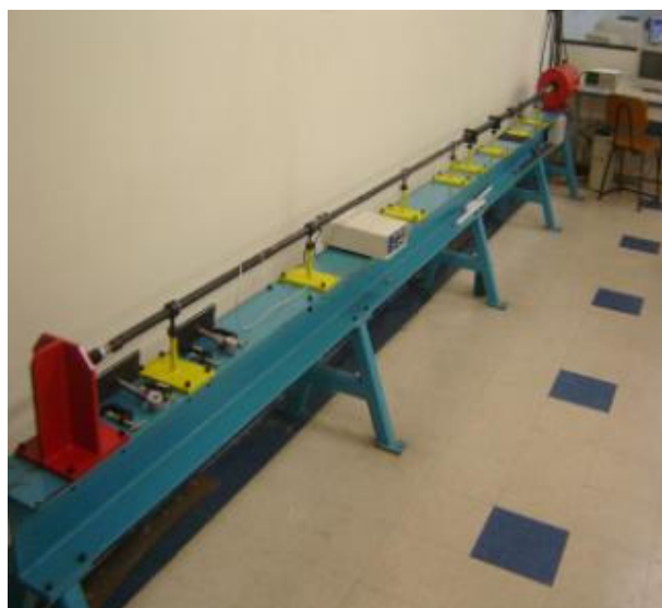
Figura 57 - Barra de Hopkinson do laboratório do GMSIE da USP.
