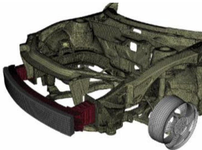
Figura 16 - Viga de impacto e crashbox de um veículo.
