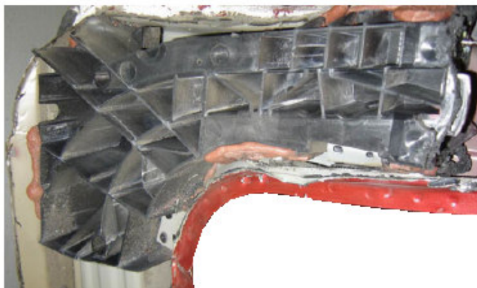
Figura 8 – Reforço de material composto após teste de impacto (Automotive Circle International, 2006).
