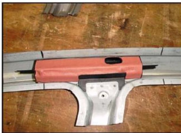
Figura 31 – Reforço estrutural no topo da coluna B (Carlson et al., 2003).
