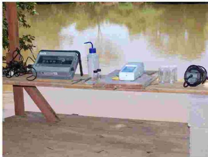
Figura 13. Bancada para disposição de aparelhos e leitura de parâmetros abióticos. Local: Rio Mogi Guaçu (Porto Ferreira – SP).
