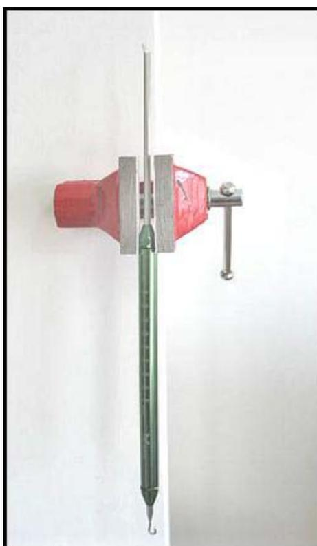
Figura 7 - Dinamômetro preso pela ponteira do corpo com gancho de tração voltado para baixo para a colocação dos pesos rastreados.
