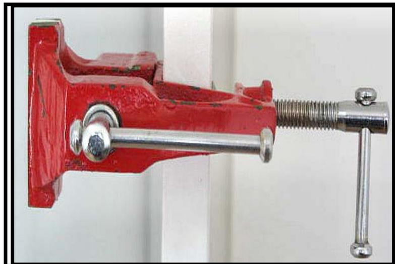
Figura 3 - Bancada com o Mini Torno Western 50 mm com as barras de apreensão presas verticalmente.
