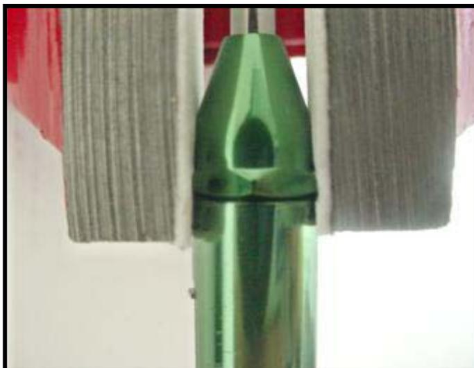
Figura 6 - Posicionamento do dinamômetro preso ao torno voltado pela ponteira do corpo na posição vertical, sem que interferisse na liberdade de tração da mola.
