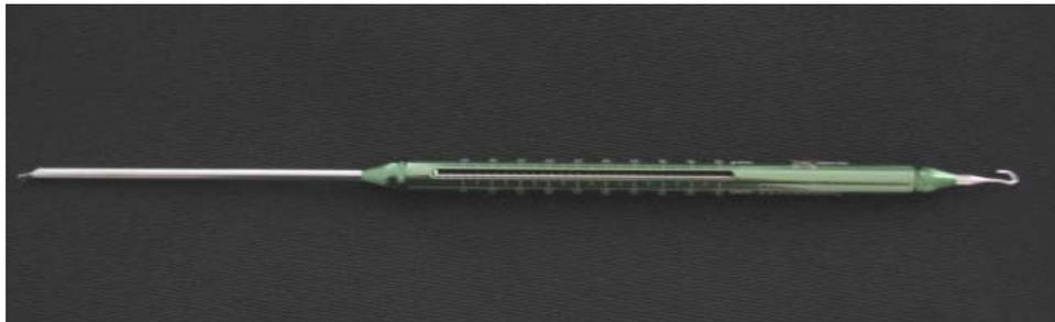
Figura 1 - Dinamômetro da marca Morelli utilizado nos testes
