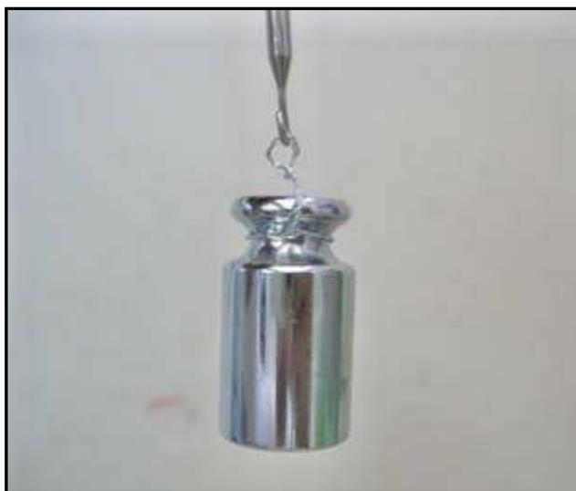
Figura 8 - Peso rastreado preso ao gancho na posição vertical sem interferências para realização dos testes.
