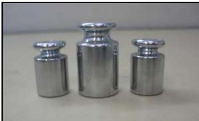
Figura 4 - Pesos Cauduro rastreados com certificação do INMETRO.
