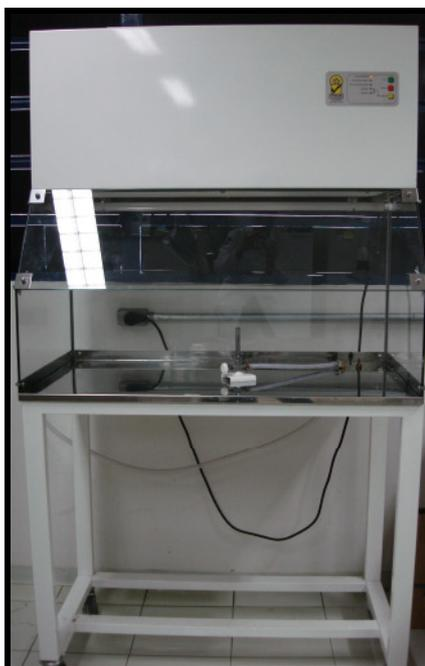
Figura 5 - Câmara de fluxo laminar Filtracom.
