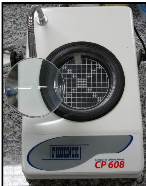
Figura 10 - Contador de colônias manual com lupa Phoenix CP 608.
