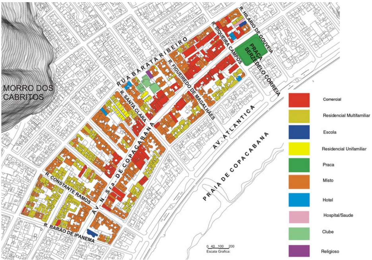
Figura 6: Trecho analisado com levantamento de usos. Nota-se uma grande quantidade de usos mistos e residenciais, o que gera um uso diversificado das edificações. Fonte: Desenho do autor sobre base da PCRJ, 2008.
