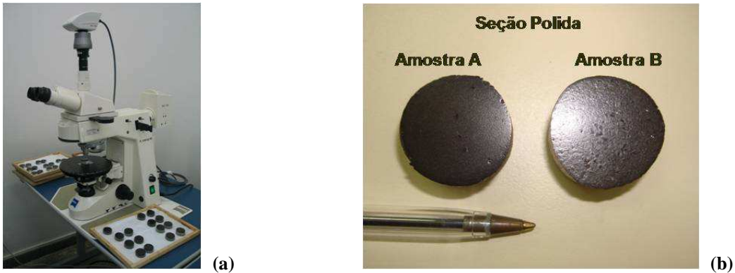
Figura 26: Detalhe da Microscopia ótica de luz refletida. (a) Microscópio ótico de luz refletida, marca Zeiss, modelo Axiolab 40; (b) Seções polidas para análises
