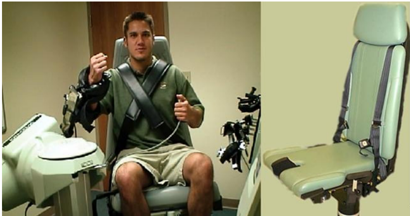
Figura 26: Mecanismos da interface paciente-máquina. Na esquerda: Paciente segurado no banco com cintos durante a avaliação do braço com dinamômetro isocinético. Na direita: banco.
