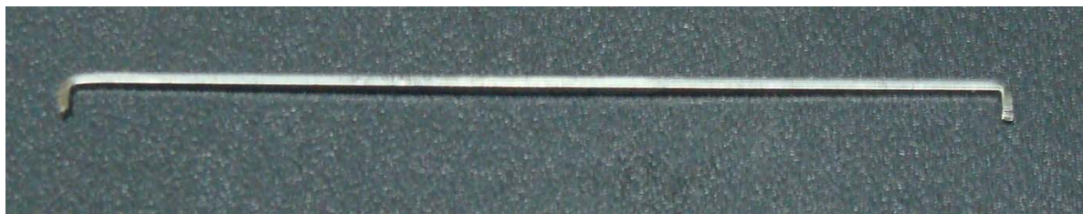
Figura 6 - Segmento de fio ortodôntico teste 0,021 x 0,025".
