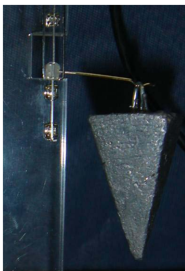
Figura 8 - Braquete teste com o peso de 100g.
