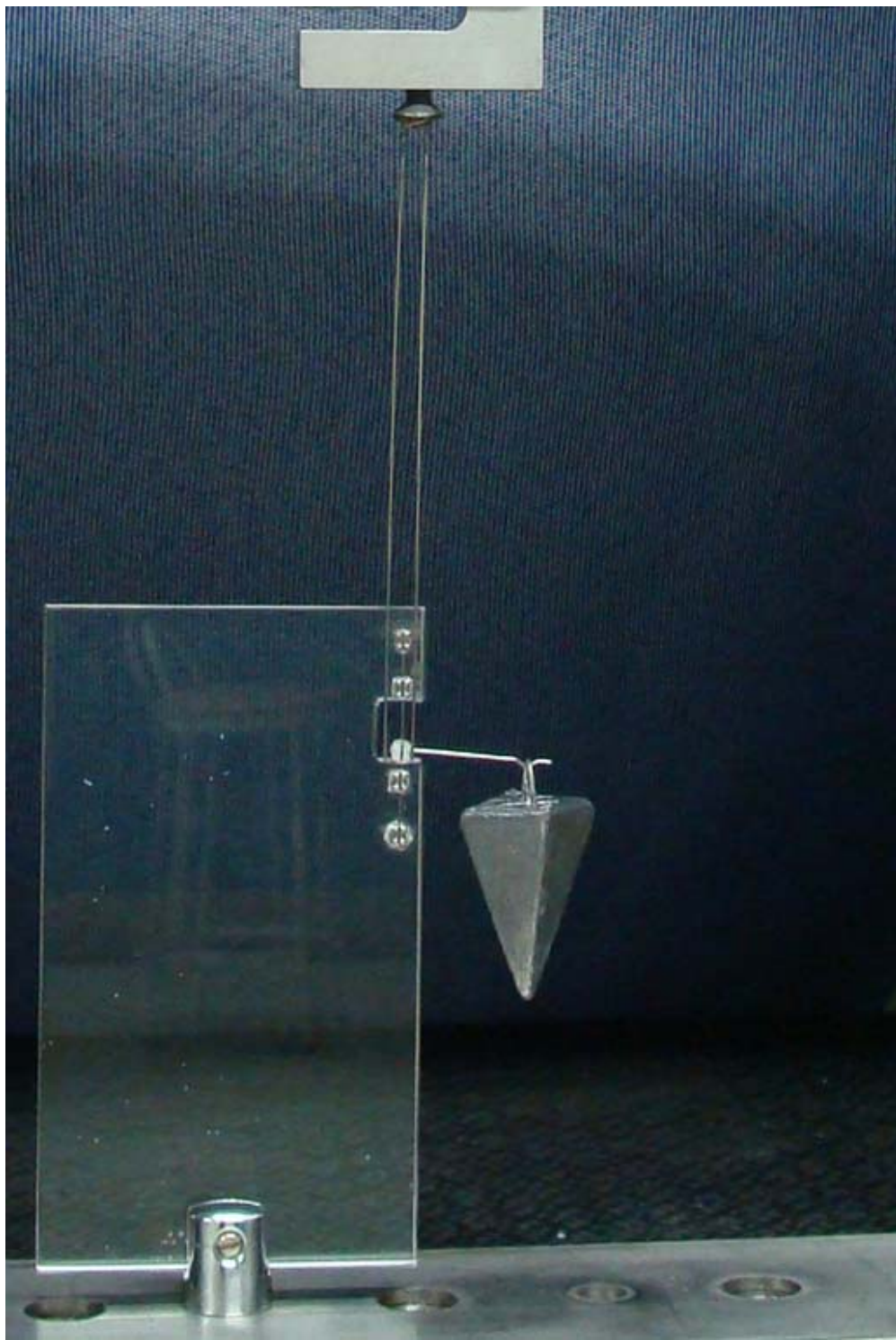
Figura 10 - Braquete teste sendo tracionado pela máquina Emic.
