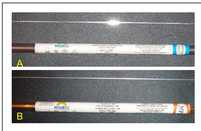
Figura 2 - Tipos de fios Ortodônticos: A) Fio de SS; B) Fio de TMA.
