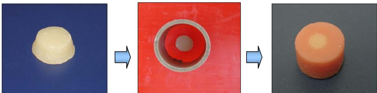
Figura 2 - Botão de resina composta inserido na resina acrílica.
