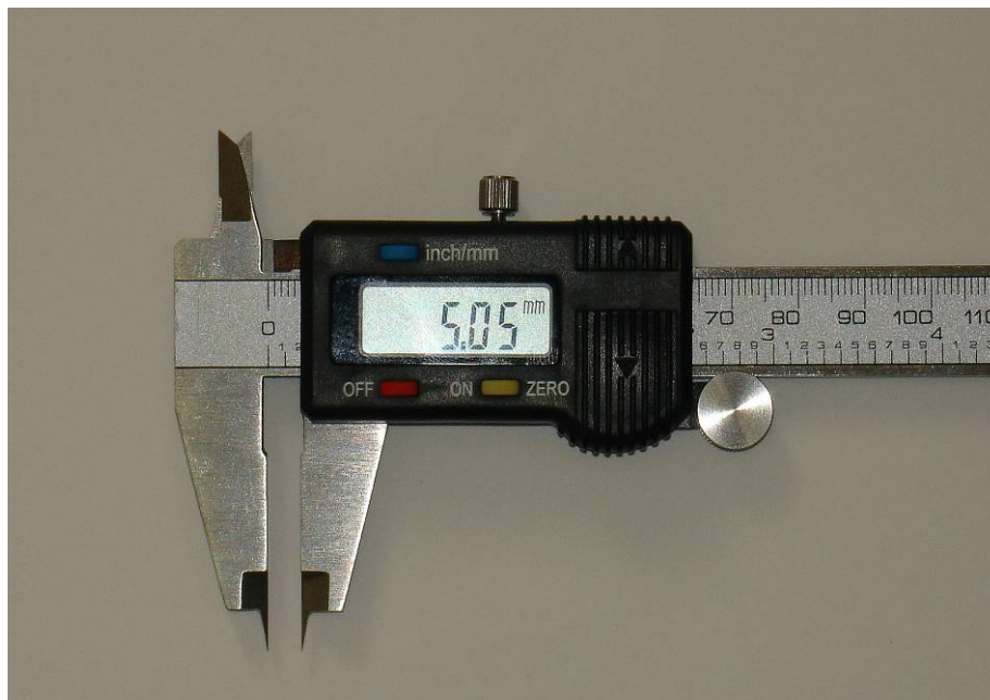
Figura 2 - Paquímetro digital adaptado para facilitar a precisão.
