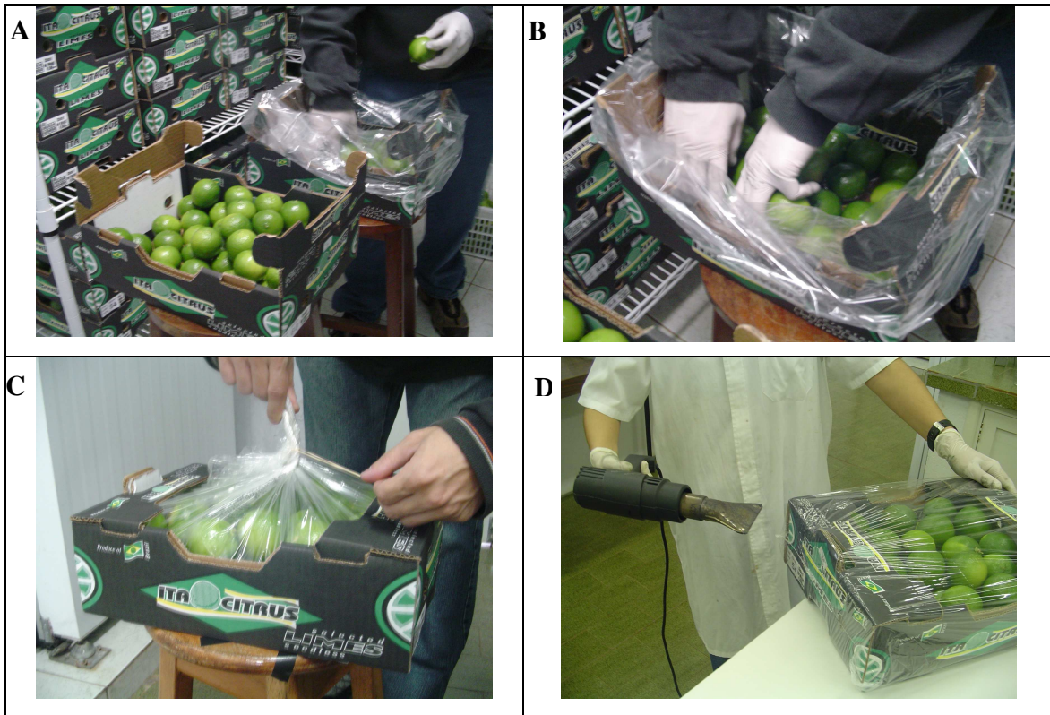
Figura 1 - Acondicionamento dos frutos em filmes plásticos do tipo PEBD e Vegetal Pack nas caixas de papelão (A, B); fechamento das embalagens (C) e preparo da embalagem termoencolhível com filme Cryovac D-955 (D)
