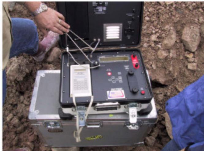
**Figura 22: Máquina de detonar Daveytronic.**
