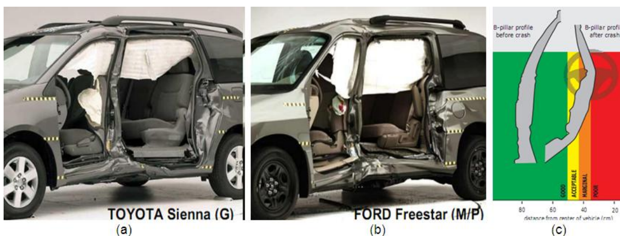
Figura 4. (a) e (b) resultado de um impacto lateral de uma barreira móvel de 1500 kg a 50 km/h; (c) padrão deformado da coluna B em que o nível intrusão é classificado como “marginal” (4).
