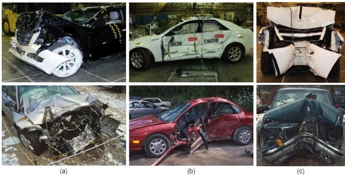
Figura 1. Comparativo entre casos de campo (superior) e crash-tests (inferior); (a) impacto frontal; (b) impacto lateral; (c) impacto contra poste 1 .
