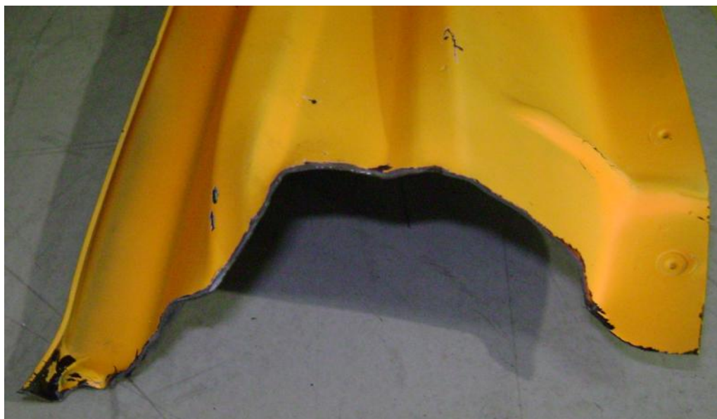
Figura 64. Vista frontal da região da ruptura do pára-choque do Teste #6.
