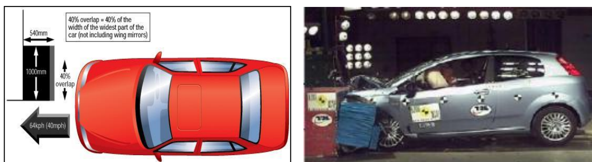
Figura 3. Impacto a 64 km/h contra barreira deformável e 40% de sobreposição (3).
