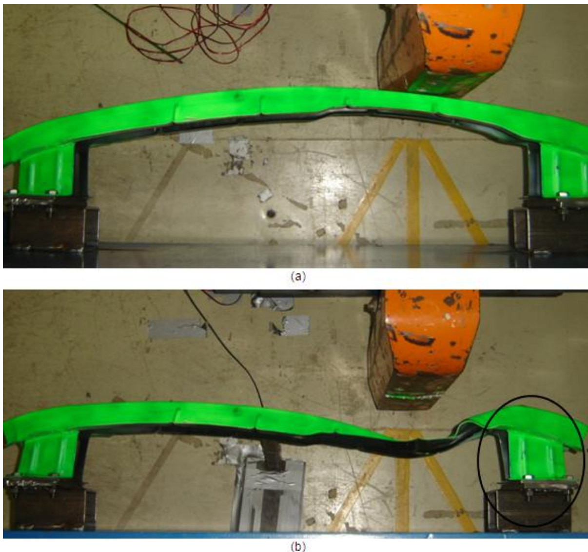
Figura 49. (a) condição do Teste #3 antes do ensaio; (b) depois do ensaio e detalhe do suporte sem colapso.
