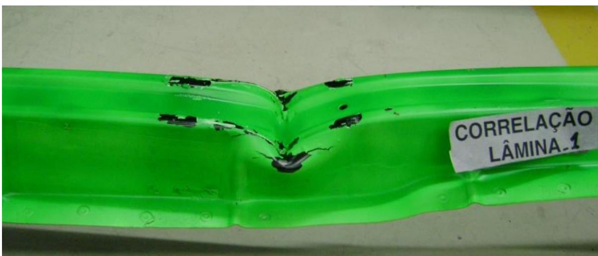
Figura 45. Detalhe das deformações no ponto de impacto do Teste #1.
