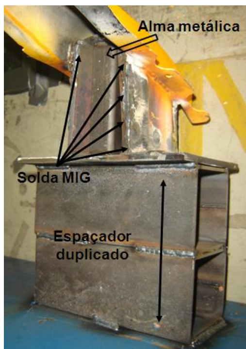
Figura 53. Detalhe da condição de contorno dos suportes para o Teste #5.
