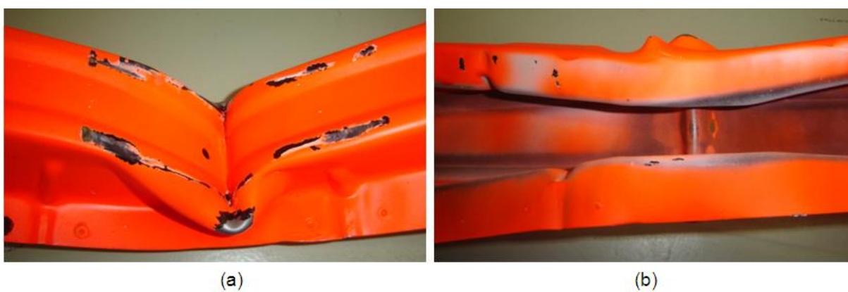
Figura 47. Detalhe das deformações no ponto de impacto do Teste #2, (a) vista externa; (b) vista interna.
