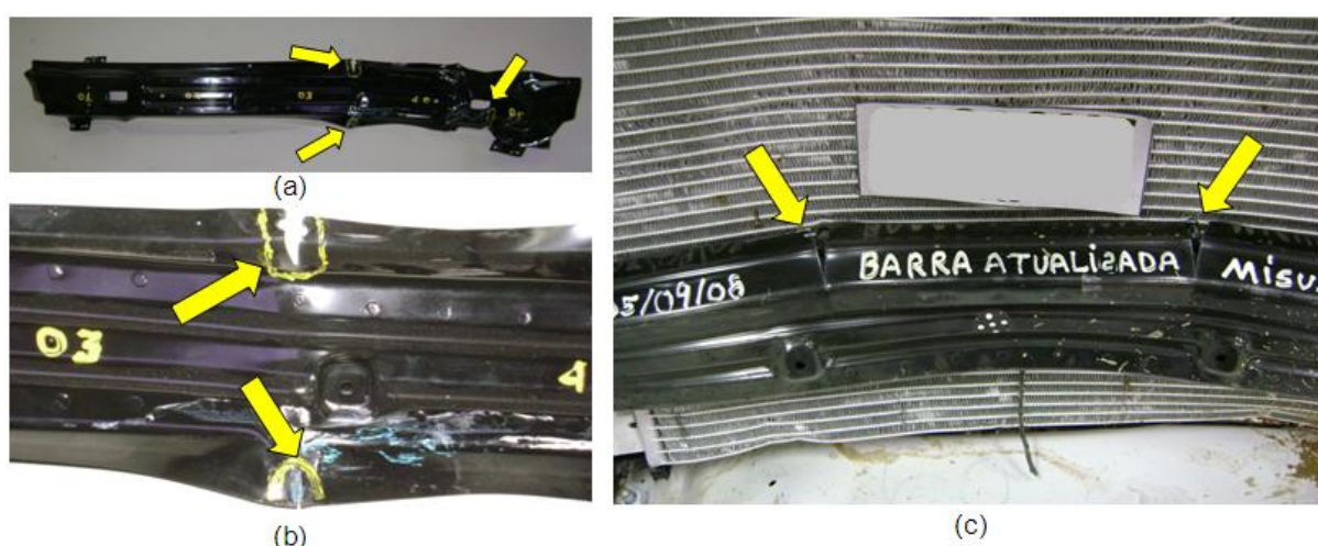
Figura 7. (a) e (b) protótipo de pára-choque após impacto de alta velocidade; (c) impacto simulando atropelamento de um animal.
