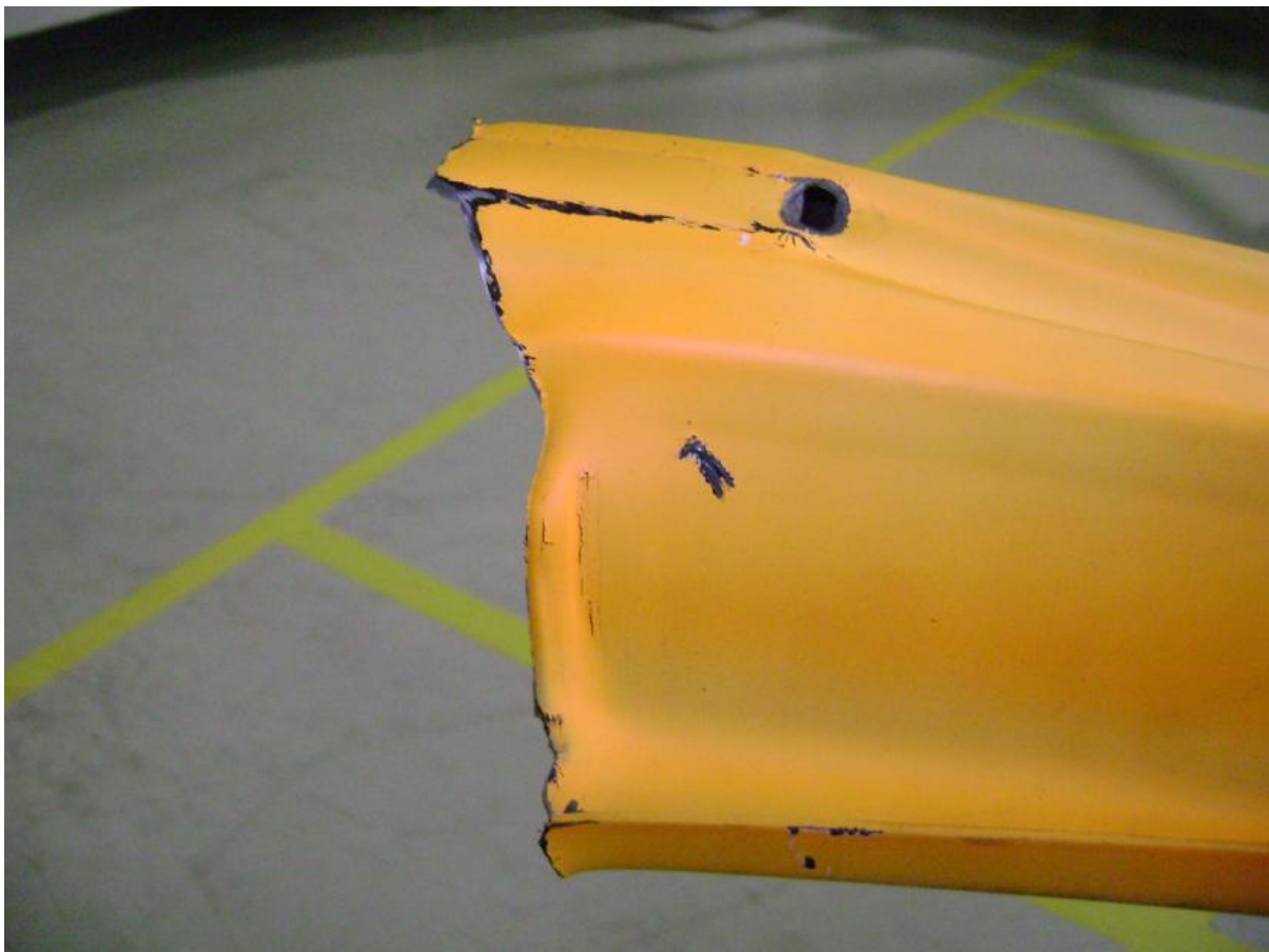
Figura 66. Vista lateral da região da ruptura apoiada pela coluna central (Teste #6).
