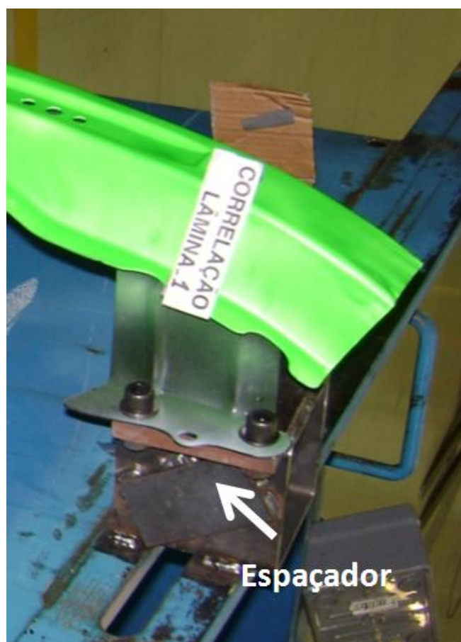
Figura 42. Detalhe das fixações do suporte do pára-choque na barreira.
