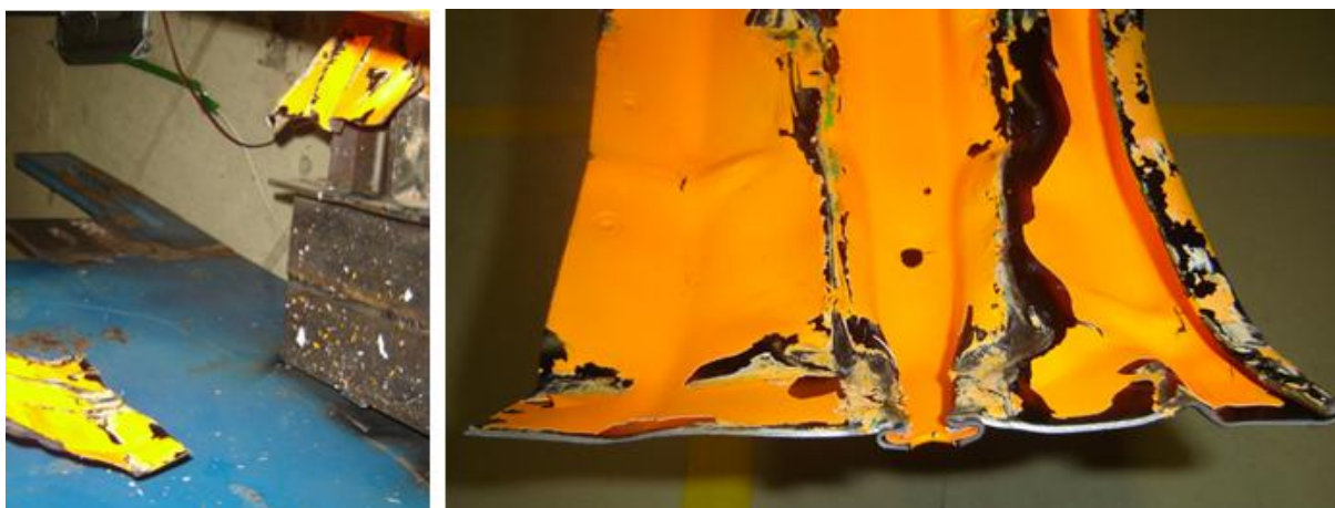
Figura 56. Detalhe da ruptura na região de impacto com o pêndulo.
