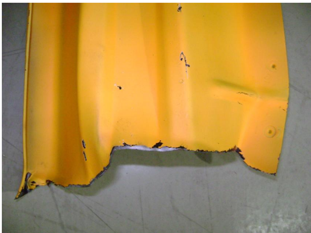
Figura 65. Vista de topo da região da ruptura do pára-choque do Teste #6.
