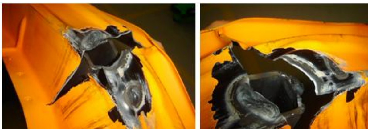
Figura 58. Ruptura iniciada na zona termicamente afetada pelo cordão de solda MIG.
