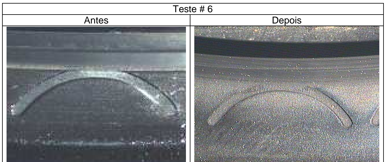
Figura 38 – Detalhe do comparativo em desgaste na região dos ribs na peça do teste # 6
