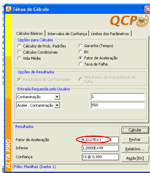
Figura 88 – Fator de aceleração gerado pelo teste.
