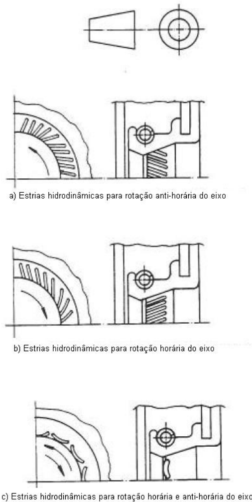
Figura 10 – Exemplificação da construção das estrias hidrodinâmicas [DIN 3760]
