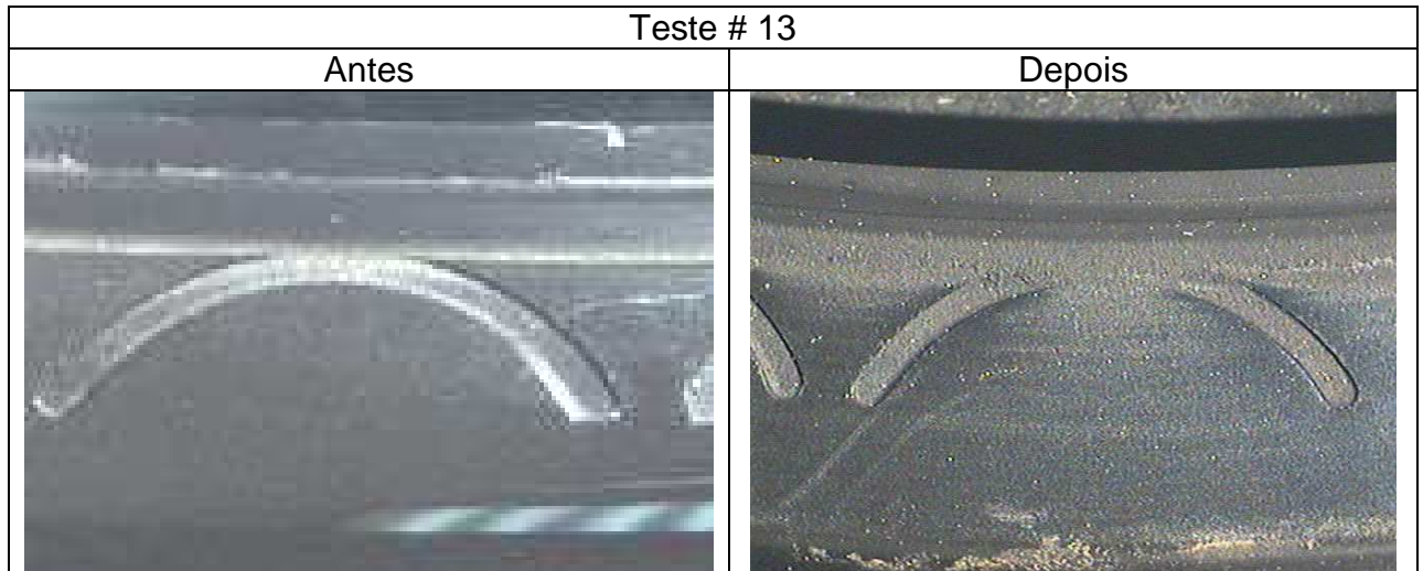
Figura 45 – Detalhe do comparativo em desgaste na região dos ribs na peça do teste # 13
