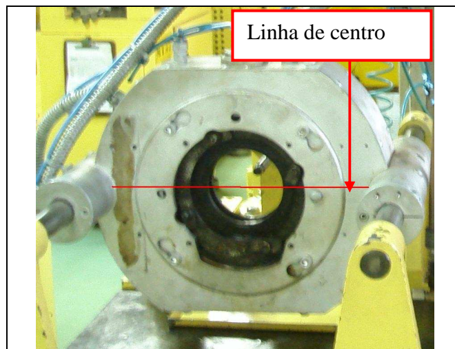
Figura 32 – Foto exemplificando condição de nível de centro do óleo
