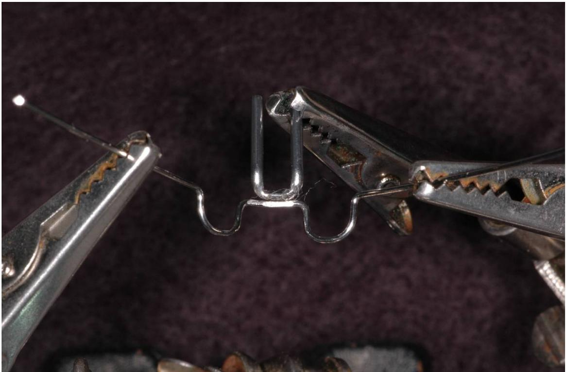
Figura 6 - Conjunto posicionado para soldagem.
