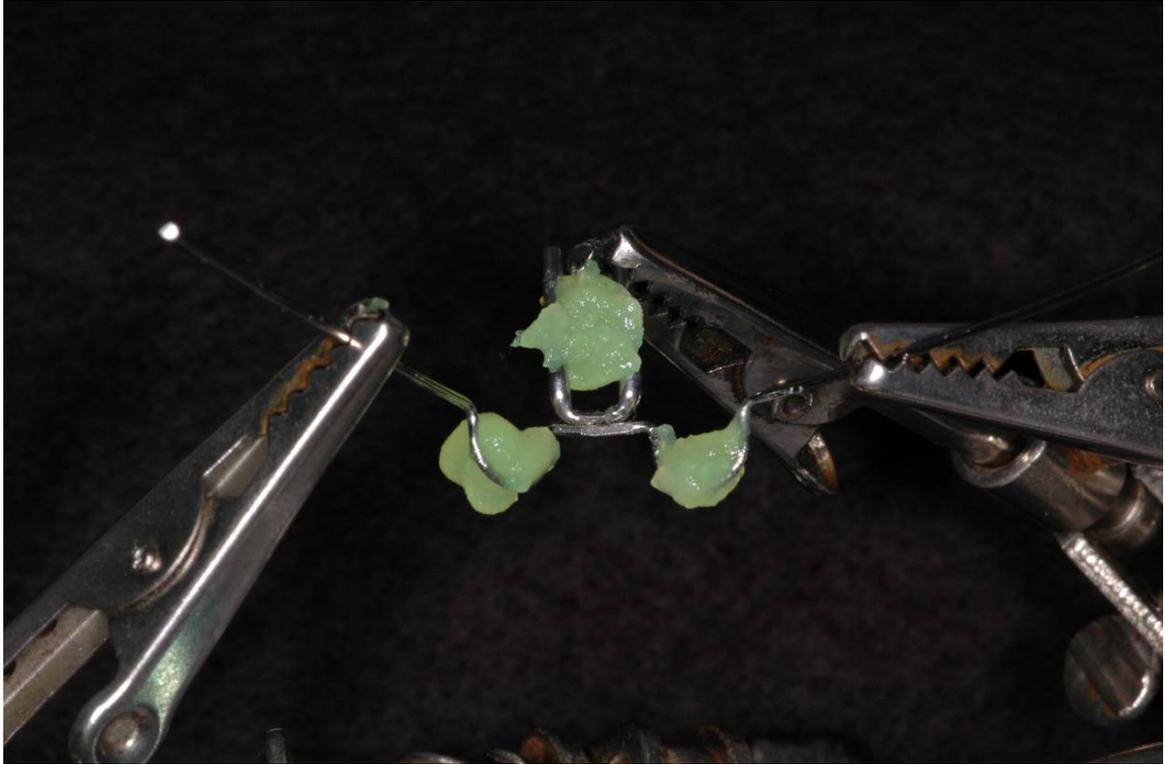
Figura 7 - Pasta termo isolante aplicada.
