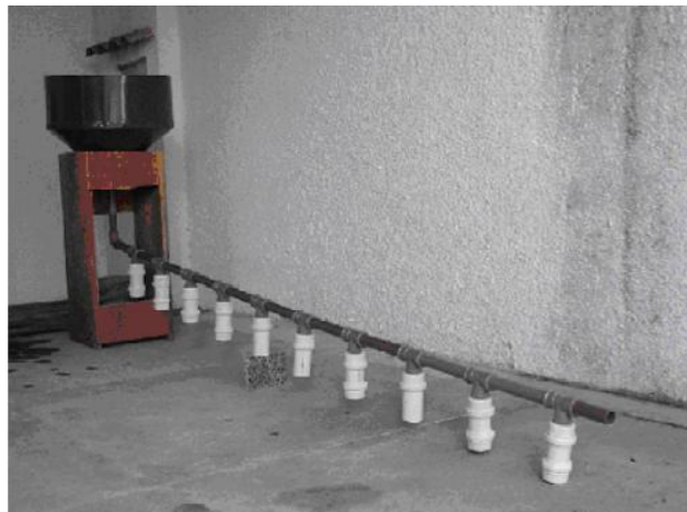
Figura 14 – Amostrador com funil de coleta e tubulações de armazenamento
