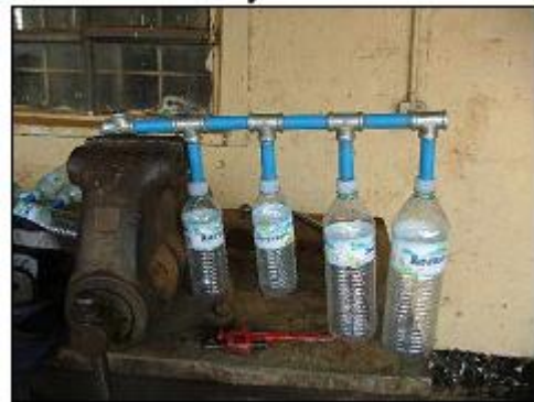
Figura 13 – Sistema de coleta de água de chuva por meio de garrafas alinhadas Fonte: Martinson (2005)
