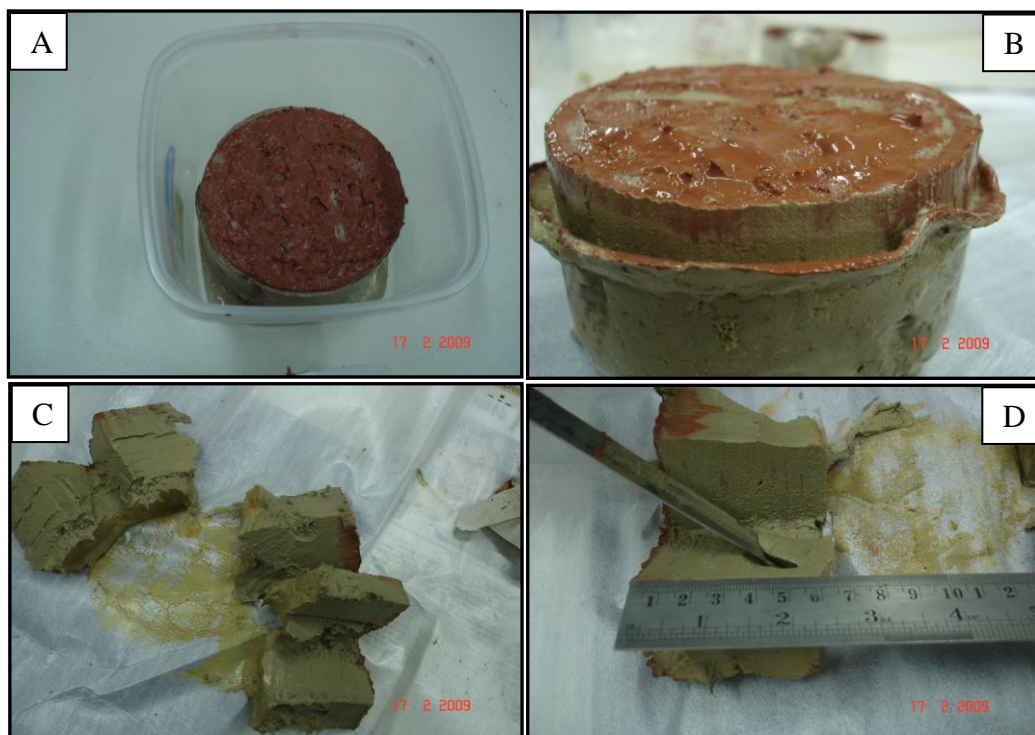
Figura 4.12 – Ensaio de difusão: A) extração da lama vermelha; B) corpo-de-prova após a retirada do molde de PVC; C) fatiamento do solo e D) coleta de amostras.
