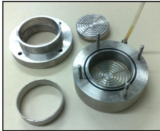
Figura 4.7 - Célula em aço inox para ensaios edométricos.
