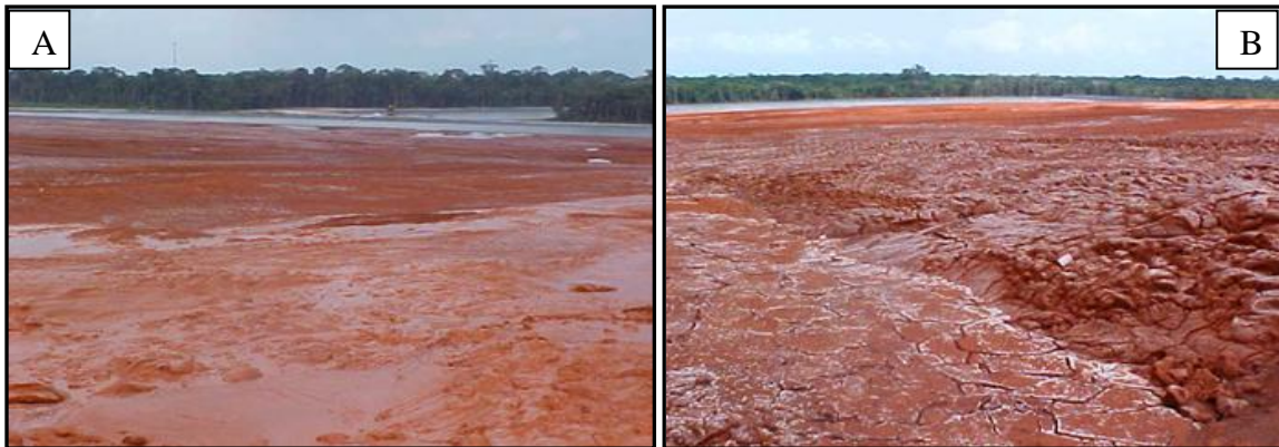
Figura 3.7 – Disposição da lama vermelha: A) no momento de lançamento; B) após certo tempo de exposição ao sol, sofrendo evaporação e formação de uma película de NaCl.
