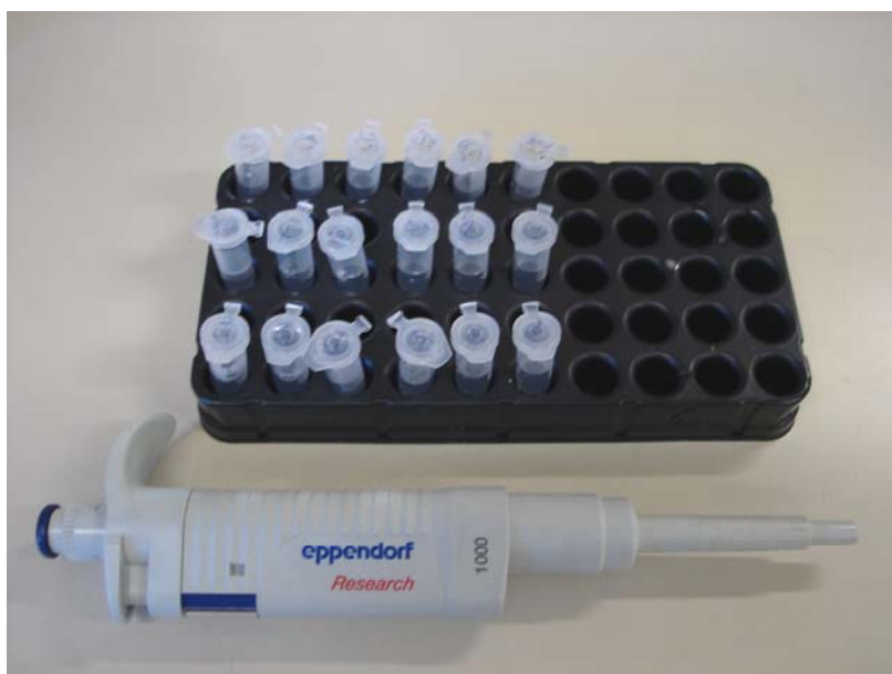
Figura 5 - Figura demonstrando uma Micropipeta Eppendorf (1000 \mu l) , suporte com frascos Eppendorf de 1,5 ml contendo água destilada para a realização da Contagem de colônias formadas por mL.
