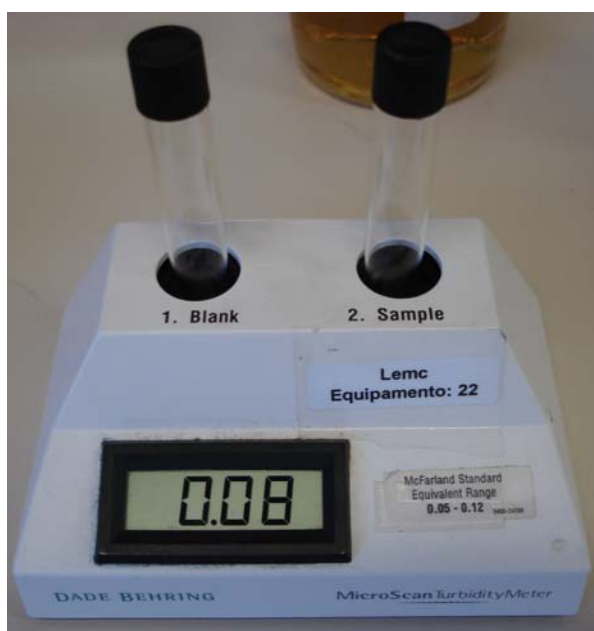
Figura 4 - Verificação no Turbidímetro de uma amostra com meio de cultura mais o medicamento diluído mostrando o valor na escala que corresponde a 0.5 na escala de McFarland.
