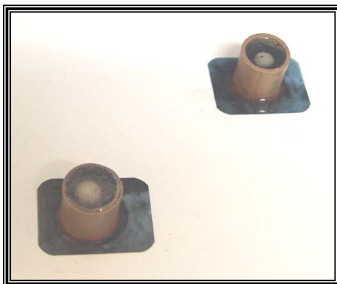
Figura 5 - Inclusão das raízes em resina acrílica.
