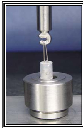
Figura 22 - Posicionamento do corpo de prova na Máquina de Ensaios Universal.
