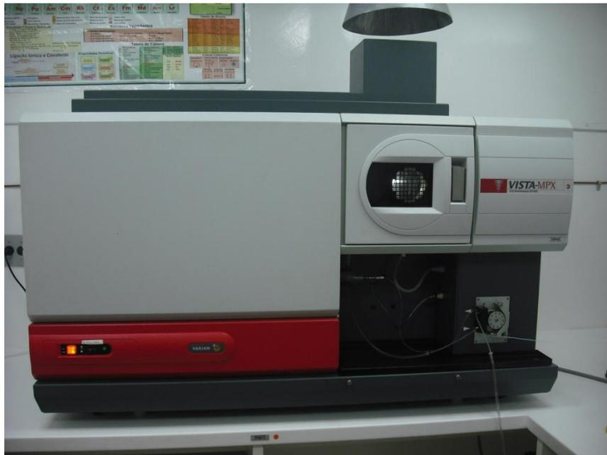
**Figura 4:** Espectrômetro de emissão óptica com plasma acoplado induzido (ICP OES)
