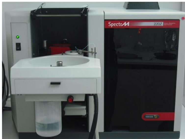
**Figura 3:** Espectrômetro de absorção atômica em forno de grafite (GFAAS)
