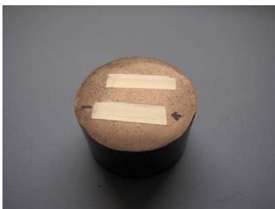
Figura 5.7. Amostra embutida de um TPGF Ni-PZT após o processo de *Sputtering*.
