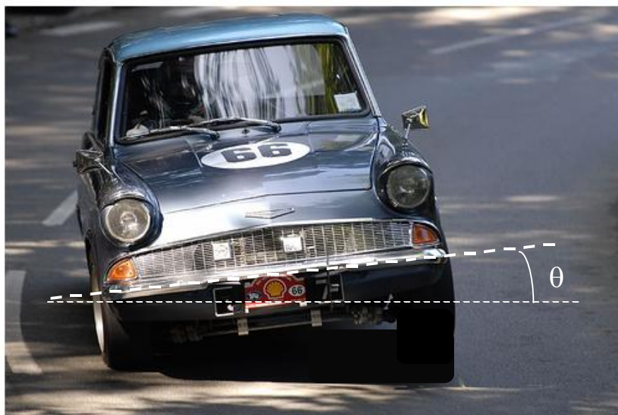
Figura 4.4 – Ângulo de Rolagem do Veículo em Curva em Regime Permanente
