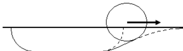
Figura 5.79 - Riser saindo da trincheira
