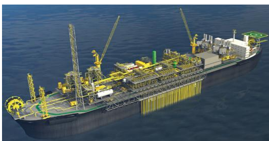
Figura 1.3 - P-57, plataforma do tipo FPSO instalada no campo Jubarte. Extraído de SBM Offshore (2009).
