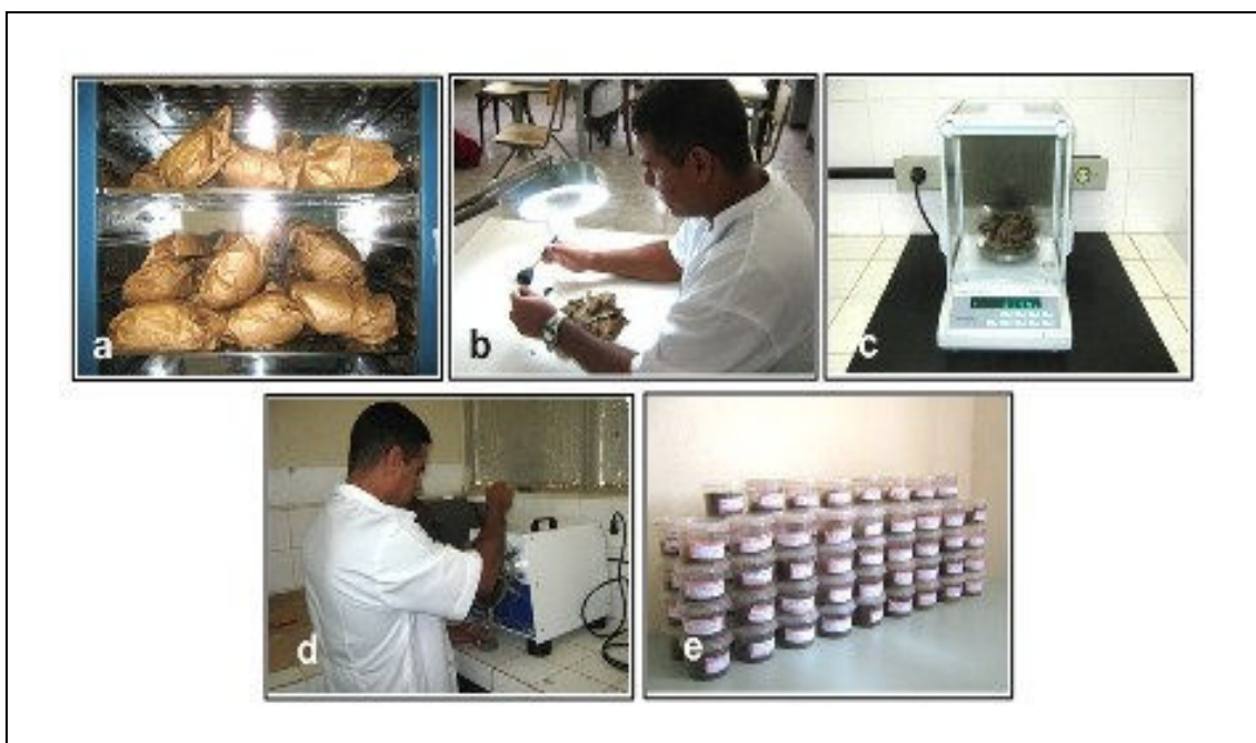
Figura 3 Etapas de preparação das amostras: secagem das folhas em sacos de papel em estufa (a); limpeza das amostras e separação das impurezas (b); pesagem do material remanescente (c); moagem da matéria seca foliar (d); amostras acondicionadas em recipientes plásticos (e).
