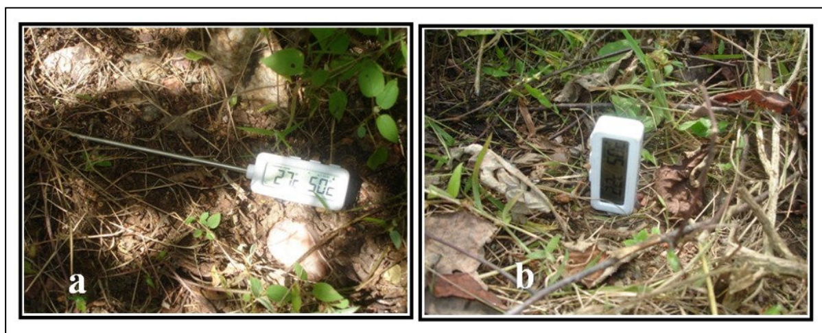
Figura 2 Termômetro digital utilizado para a determinação da temperatura do solo na superfície (a) e a 15,0 cm de profundidade (b).
