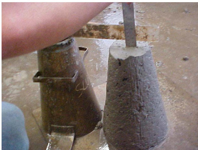
FIGURA 22 - ABATIMENTO DO TRONCO DE CONE ( SLUMP TEST ).
