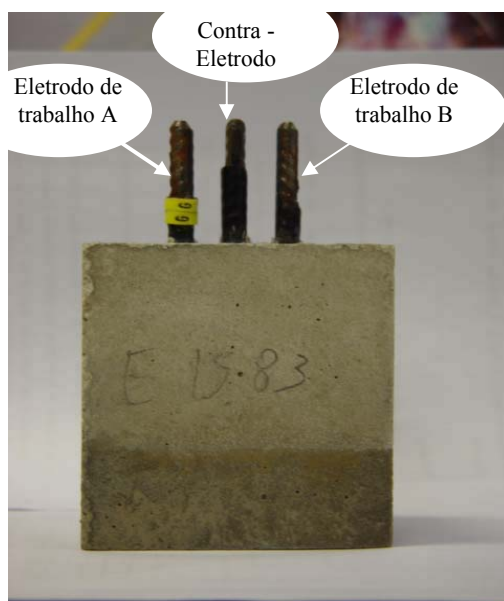
FIGURA 12 –CONCRETO COM LODO DEMONSTRANDO OS ELETRODOS.
