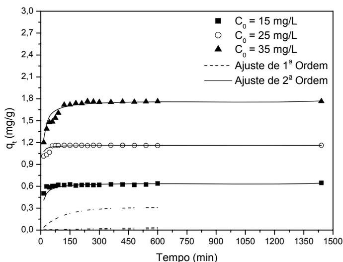
Figura 5.21 - Curvas experimentais dos ensaios cinéticos da adsorção do chumbo em carvão ativado e respectivos ajustes aos modelos de primeira e pseudo-segunda ordem: T de 25 °C; pH de 6 e  $C_{\text{carvão}}$  de 20 g/L.
