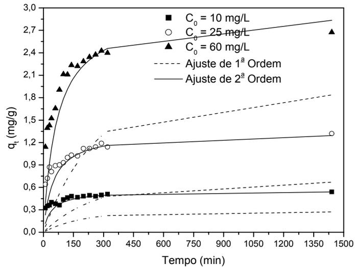
Figura 5.19 - Curvas experimentais dos ensaios cinéticos da adsorção do cobre em carvão ativado e respectivos ajustes aos modelos de primeira e pseudo-segunda ordem: T de 25 °C; pH de 6 e  $C_{\text{carvão}}$  de 20 g/L.
