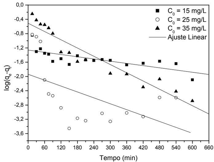
Figura 5.13 - Curvas de ajuste linear para o modelo de primeira ordem dos ensaios cinéticos da adsorção do chumbo em carvão ativado: T de 25°C; pH de 6 e C<sub>carvão</sub> de 20g/L.
