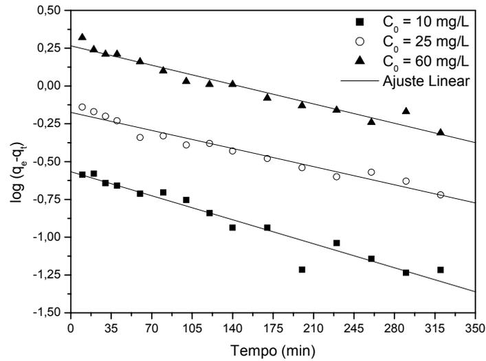
Figura 5.10 - Curvas de ajuste linear para o modelo de primeira ordem dos ensaios cinéticos da adsorção do cobre em carvão ativado: T de 25°C; pH de 4 e C<sub>carvão</sub> de 20 g/L.
