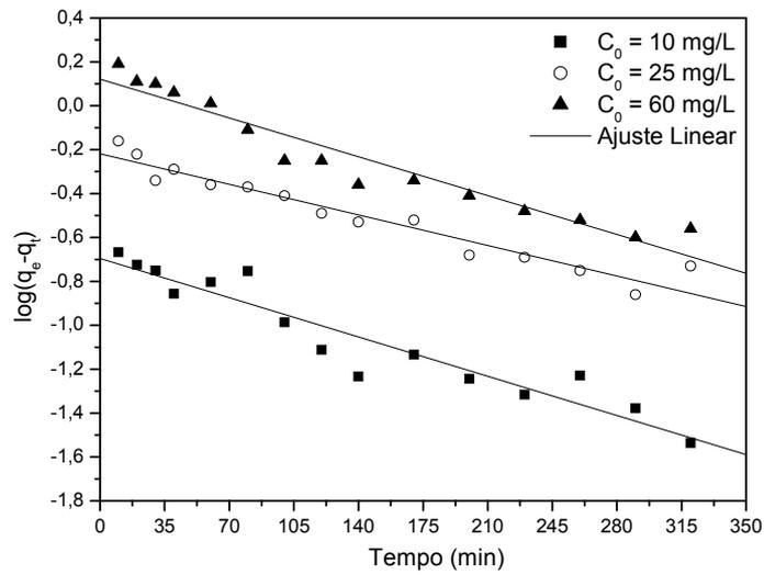
Figura 5.12 - Curvas de ajuste linear para o modelo de primeira ordem dos ensaios cinéticos da adsorção do cobre em carvão ativado: T de 25°C; pH de 6 e C<sub>carvão</sub> de 20 g/L.
