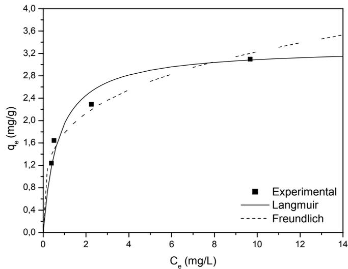
Figura 5.25 - Curvas experimentais dos ensaios de equilíbrio da adsorção do cobre em carvão ativado e respectivos ajustes aos modelos de Langmuir e Freundlich: T de 25 °C, pH de 6,  $C_{Cu}^{inicial}$  de 25 mg/L e  $C_{carvão}$  de 20 g/L
