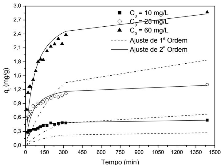
Figura 5.18 - Curvas experimentais dos ensaios cinéticos da adsorção do cobre em carvão ativado e respectivos ajustes aos modelos de primeira e pseudo-segunda ordem: T de 25 °C; pH de 4 e  $C_{\text{carvão}}$  de 20 g/L.
