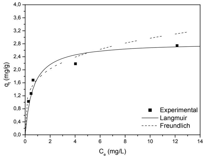
Figura 5.24 - Curvas experimentais dos ensaios de equilíbrio da adsorção do cobre em carvão ativado e respectivos ajustes aos modelos de Langmuir e Freundlich: T de 25 °C, pH de 4,  $C_{Cu}^{inicial}$  de 25 mg/L e  $C_{carvão}$  de 20 g/L
