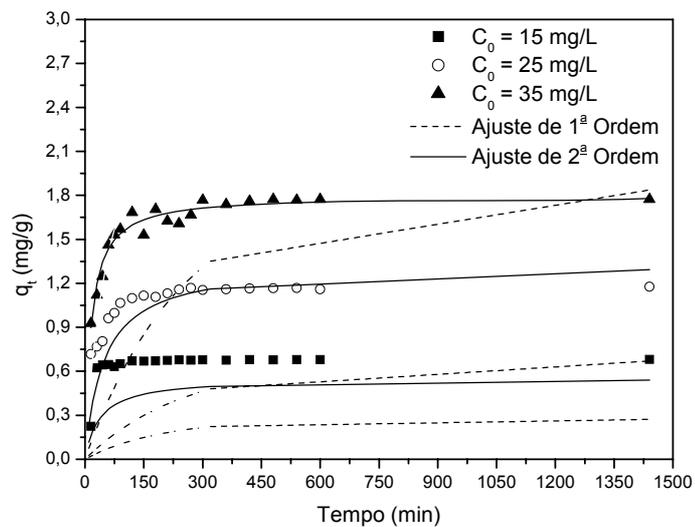
Figura 5.20 - Curvas experimentais dos ensaios cinéticos da adsorção do chumbo em carvão ativado e respectivos ajustes aos modelos de primeira e pseudo-segunda ordem: T de 25 °C; pH de 4 e  $C_{\text{carvão}}$  de 20 g/L.
