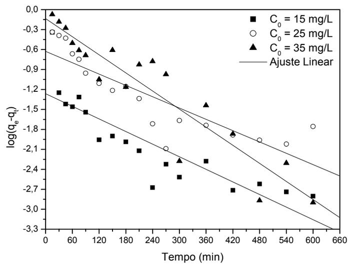
Figura 5.11 - Curvas de ajuste linear para o modelo de primeira ordem dos ensaios cinéticos da adsorção do chumbo em carvão ativado: T de 25°C; pH de 4 e C<sub>carvão</sub> de 20g/L.
