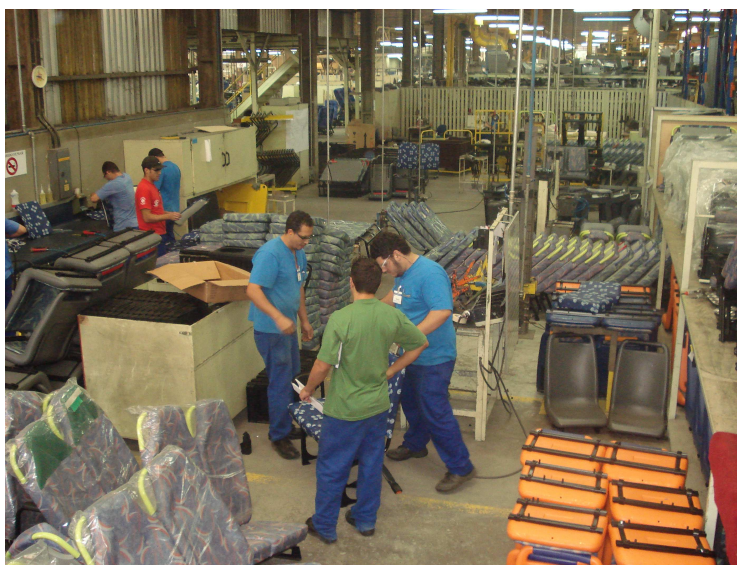
Figura 35 – Etapa de montagem de poltronas do segmento urbano antes da melhoria
