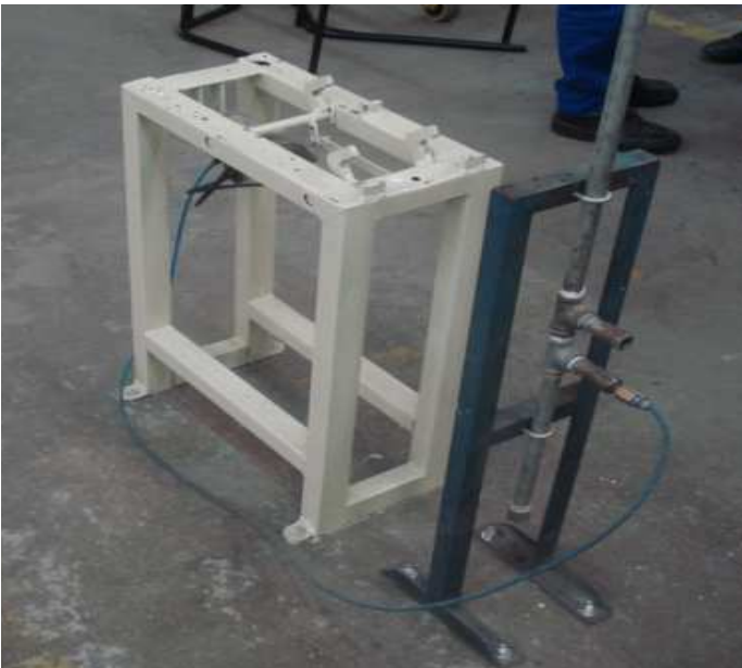
Figura 26 – Gabarito fixo - montagem do pega-mão
