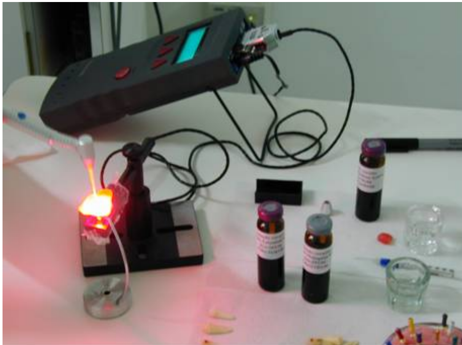
Figura 10 - Dente irrigado com um dos corantes sendo irradiado e a leitura da transmissividade sendo feita pelo Power Meter
