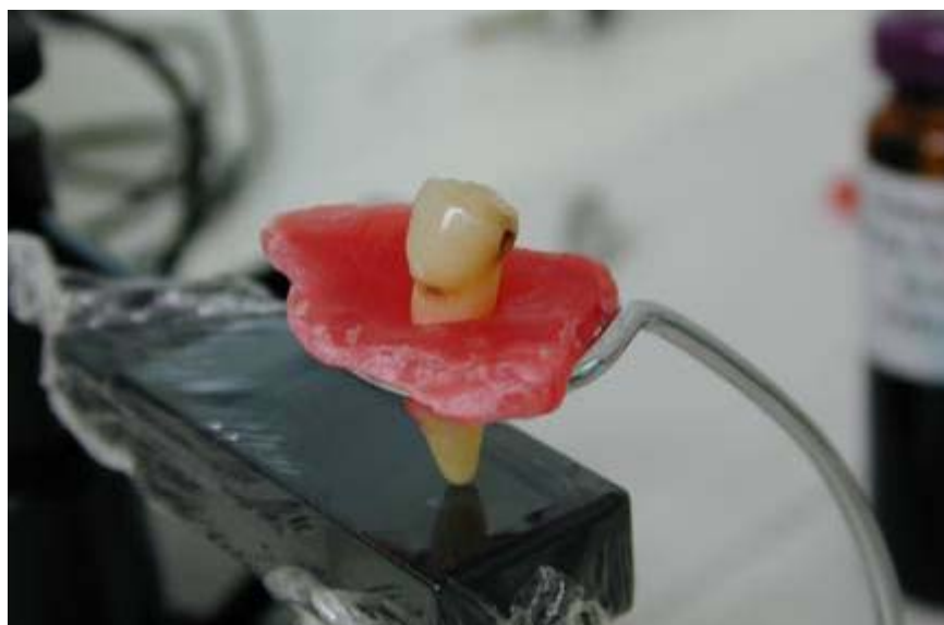
Figura 4 - Dente fixado a estativa e com o ápice em contato com o sensor do Power Meter
