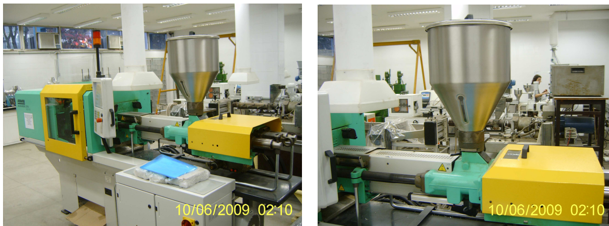
Figura 4.4 – Injetora Arburg Allrounder 270S 400-170 usada na preparação dos corpos de prova. O equipamento pertence ao Instituto de Macromoléculas Professora Eloisa Mano (IMA), da UFRJ.
