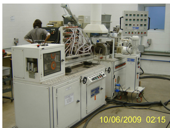
Figura 4.1 – Extrusora Dupla Rosca, Modelo DCT-20 Teck-Trill usada na extrusão dos nanocompósitos. O equipamento pertence ao Instituto de Macromoléculas Professora Eloisa Mano (IMA), da UFRJ.
