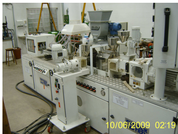
Figura 4.1 – Extrusora Dupla Rosca, Modelo DCT-20 Teck-Trill usada na extrusão dos nanocompósitos. O equipamento pertence ao Instituto de Macromoléculas Professora Eloisa Mano (IMA), da UFRJ.
