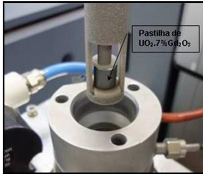
Figura 5.5 – Posicionamento da amostra sob a haste.
