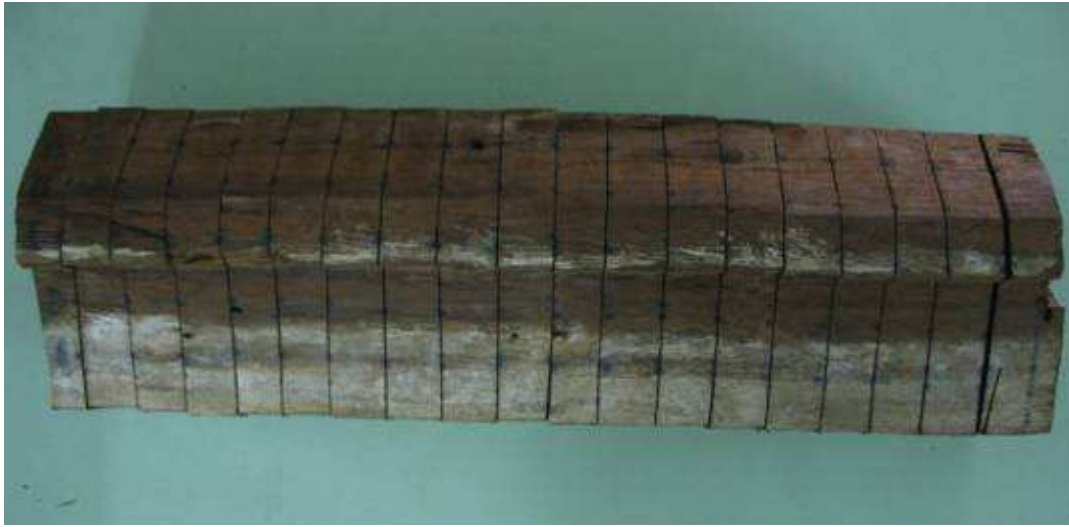
FIGURA 4.41 – Cortes transversais realizados na peça do ensaio com o transdutor de 150 kHz.
