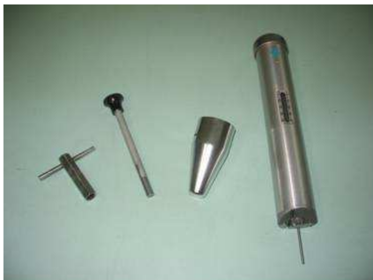
FIGURA 2.5 – Instrumento de medição da resistência ao furo: Pilodyn.
