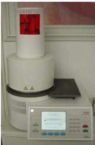
FIGURA 6 - Forno EP 600 (Ivoclar Vivadent) para a fundição das pastilhas de IPS Empress
