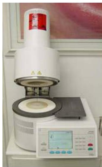
FIGURA 12 - Forno EP 600 (Ivoclar Vivadent) para fundição das pastilhas de IPS Empress 2. É o mesmo equipamento utilizado para o IPS Empress, porém com programa diferente
