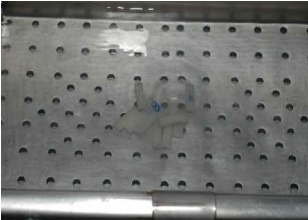
Figura 12 - Espécimes durante vibração ultrassônica, podendo-se observar as ondas produzidas pelas vibrações.
