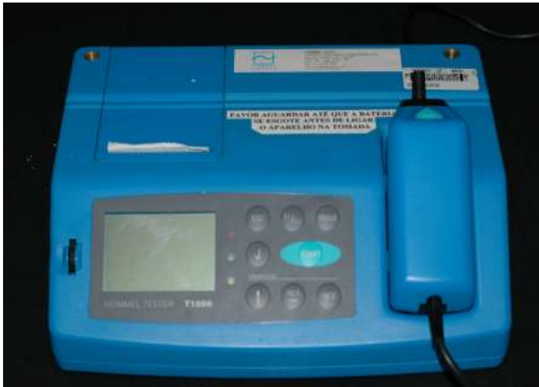
Figura 4 - Rugosímetro Hommel Tester T 1000 utilizado para medir as rugosidades
