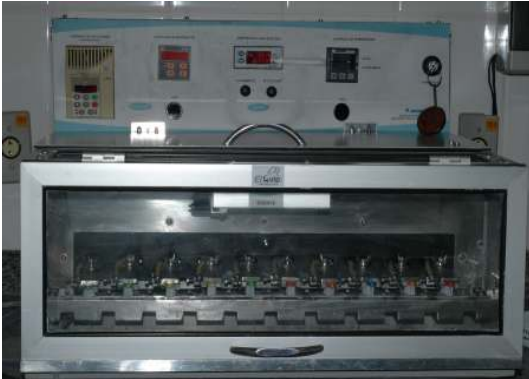
Figura 9 - Máquina utilizada para os testes de escovação simulada
