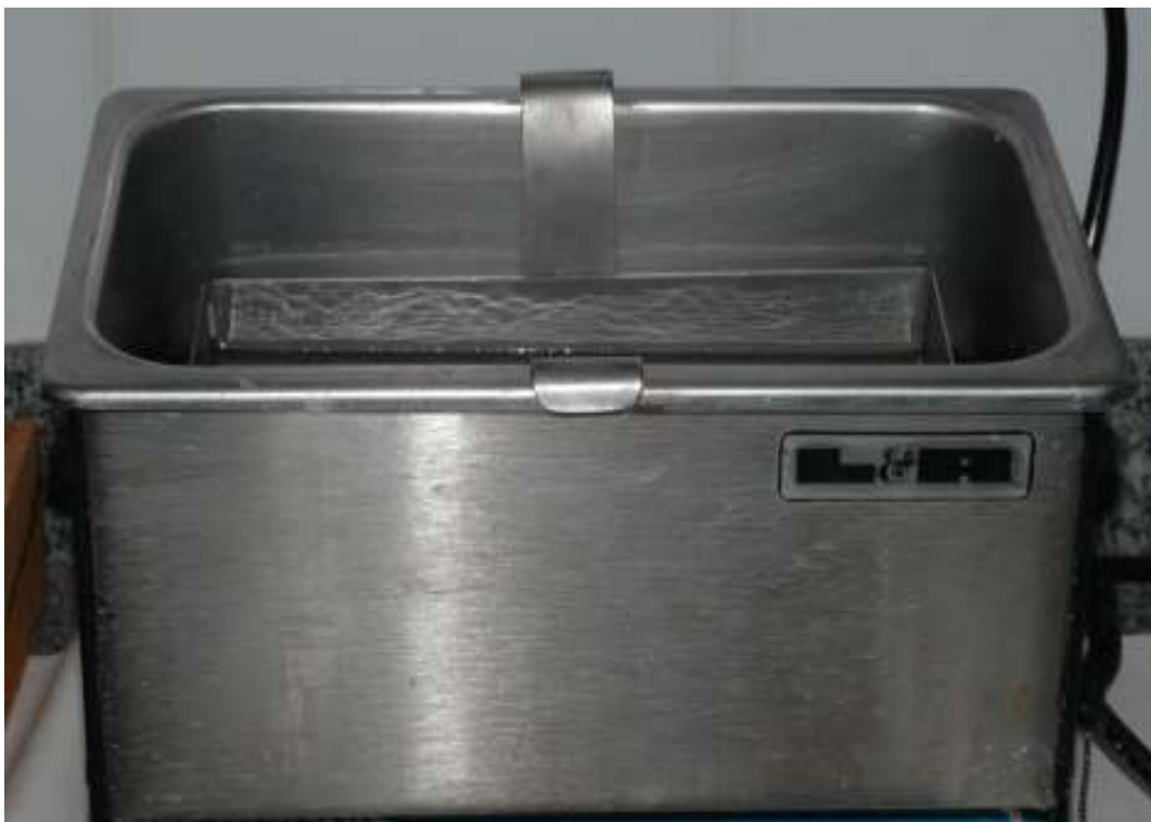
Figura 11 - Tempo Ultrasonic: máquina utilizada para vibração e limpeza dos corpos de prova.
