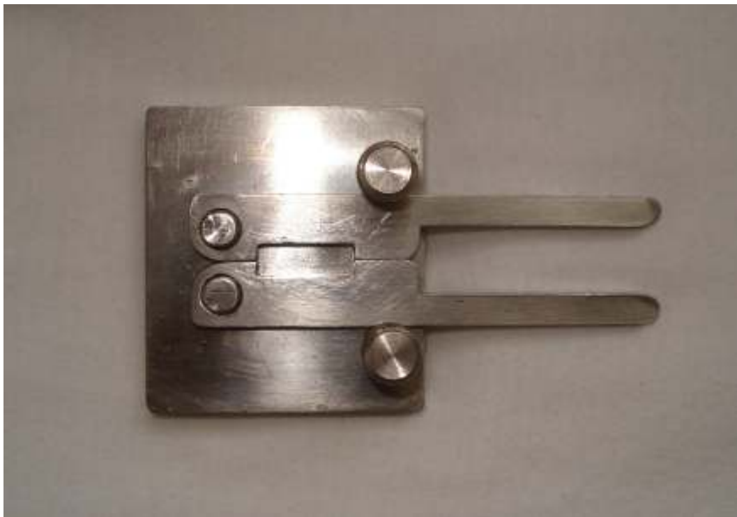
Figura 2 - Matriz de aço inoxidável utilizada para confecção dos corpos de prova
