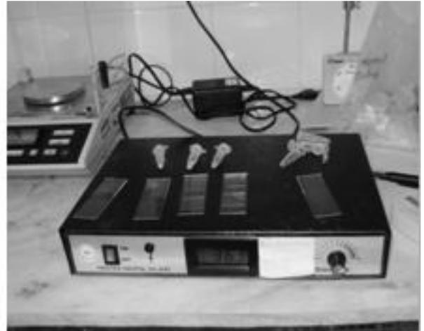
Figura 10 – Placa aquecedora (Master Digital AS 300)
