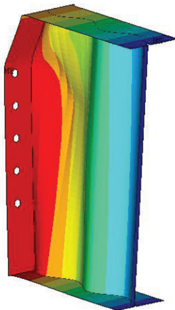
Figura 4.32 – Desenvolvimento parcial do campo de tração na alma
