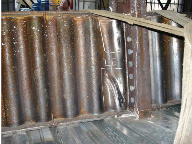
FIGURA 3.18 – Deformação da alma do Protótipo 1 após o término do ensaio
