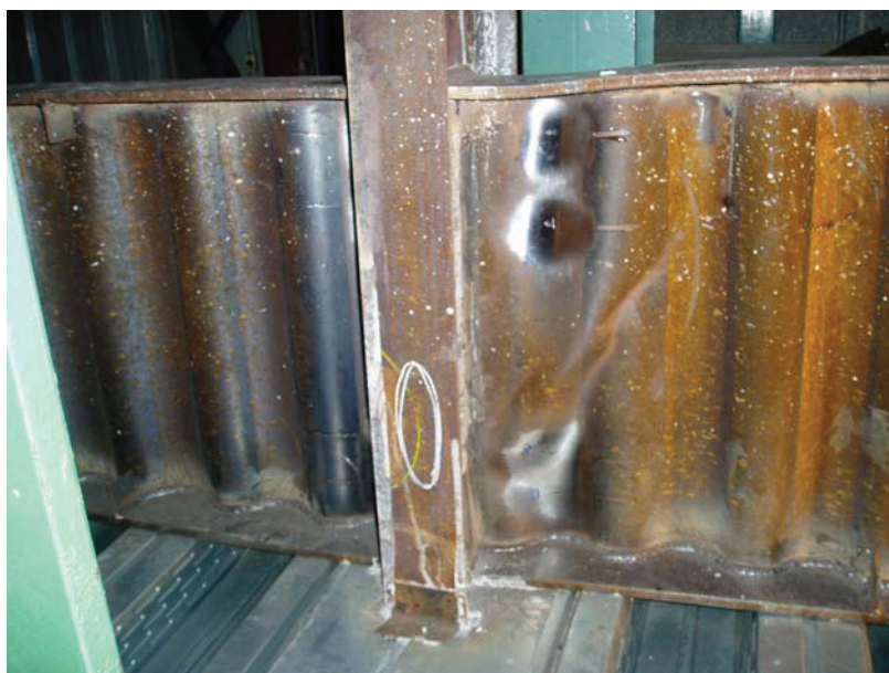
FIGURA 3.16 – Deformação da mesa e da alma na região da ligação no final do ensaio (Protótipo 2)
