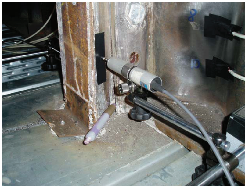
FIGURA 3.10 – Deformação na chapa de topo da ligação
