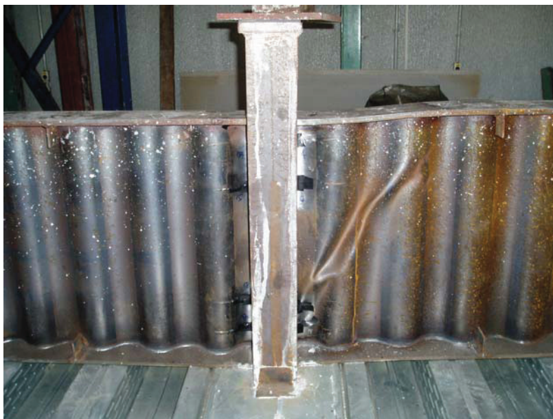
FIGURA 3.15 – Deformação da mesa e da alma na região da ligação no final do ensaio (Protótipo 3)
