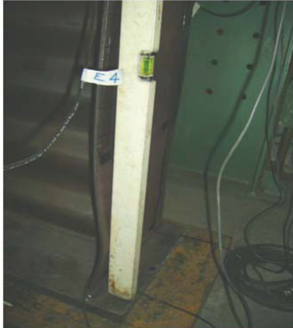
FIGURA 2.31 - Flambagem local da mesa – ensaio do protótipo 4A [PINTO (2008)]
