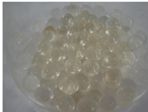
Figura 30 - Esfera de hidrogel hidratada com solução de enzima.
