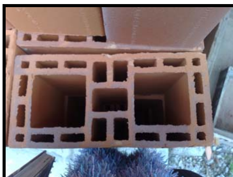
Figura 37 – bloco de alvenaria estrutural nas dimensões 140x190x290 mm
