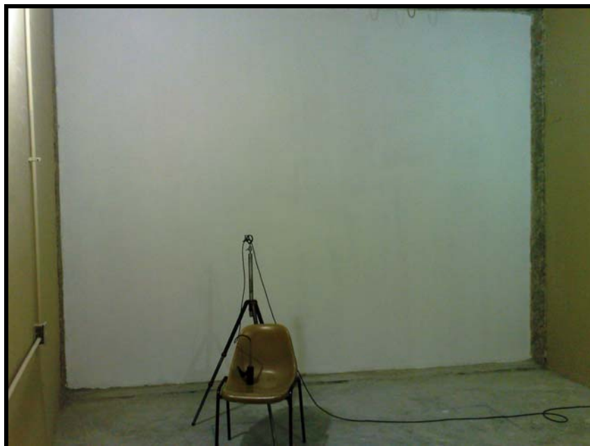
Figura 29 – Parede com 2 demãos de tinta em sua face externa – câmara de emissão
