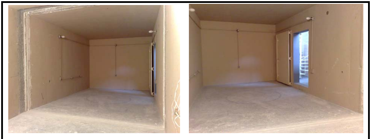
Figura 20 – vista das câmaras de emissão e recepção.
