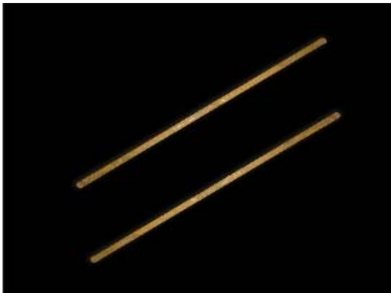
Figura 7 - Barras espaçadoras metálicas.
