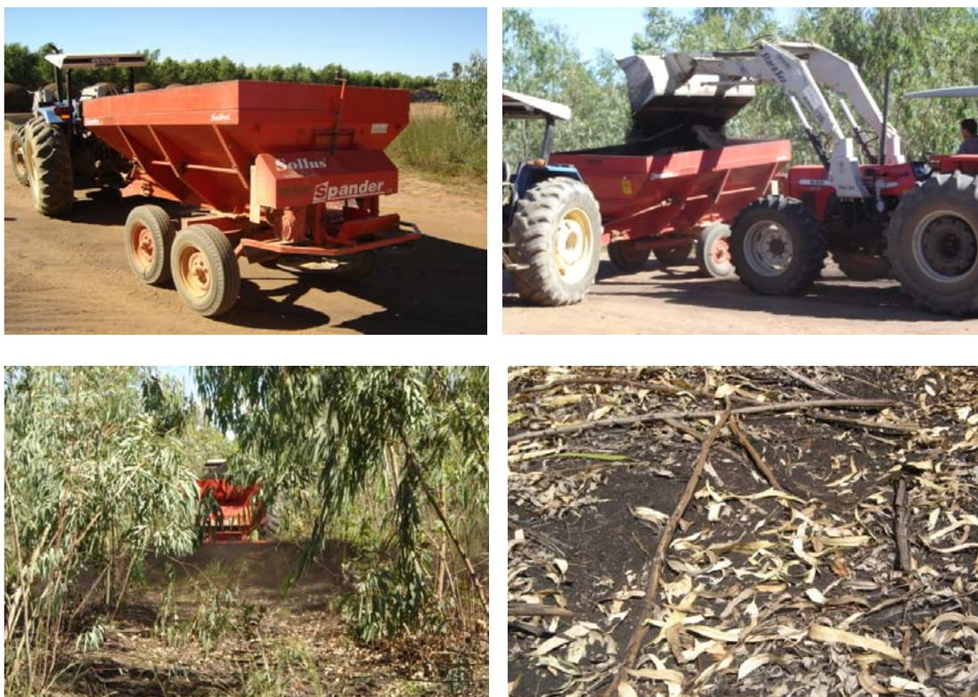
Figuras 9a, 9b, 9c e 9d. Detalhe do implemento utilizado para a distribuição dos resíduos desde seu carregamento, a distribuição e da área após a distribuição.
