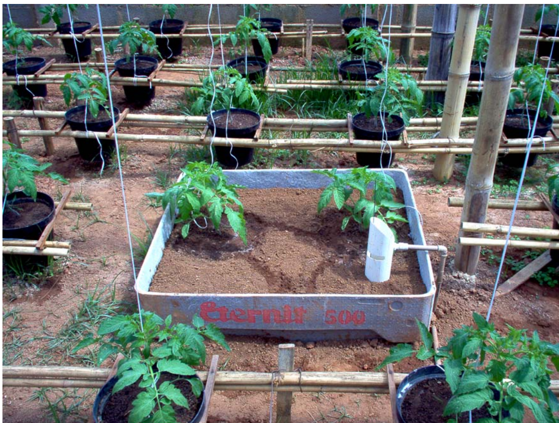
Figura 2. Lisímetro de percolação instalado no meio do experimento para determinação do volume de água de irrigação.
