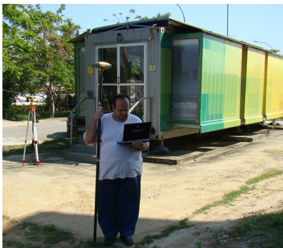
Figura 49 – Estação Base e receptor Rover sendo utilizados na obra do LabCog.
