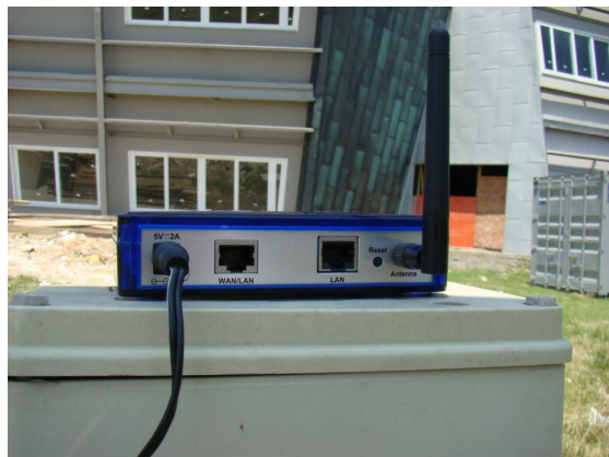
Figura 51 – Foto da parte de trás do Ponto de Acesso Zinwell sendo utilizado em testes.
