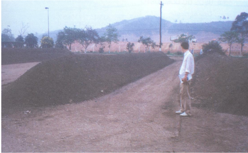
Figura 2.6: Leiras de compostagem na usina de Santo André, SP (BIDONE et al. , 1999).
