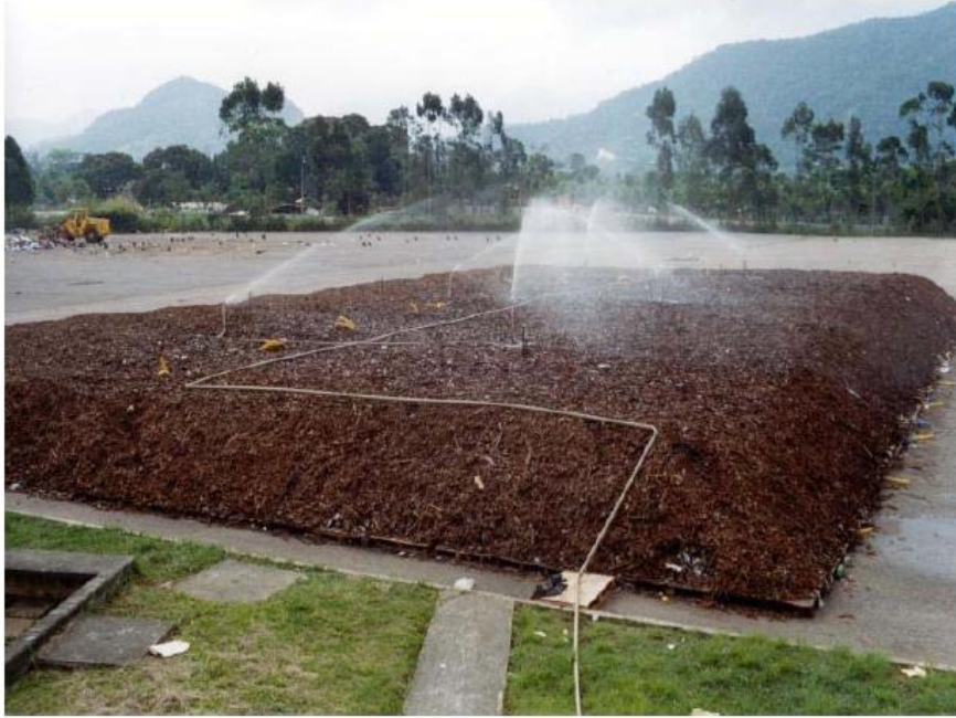
Figura 2.8: Leiras do pré-tratamento mecânico biológico (MÜNNICH et al. , 2002).
