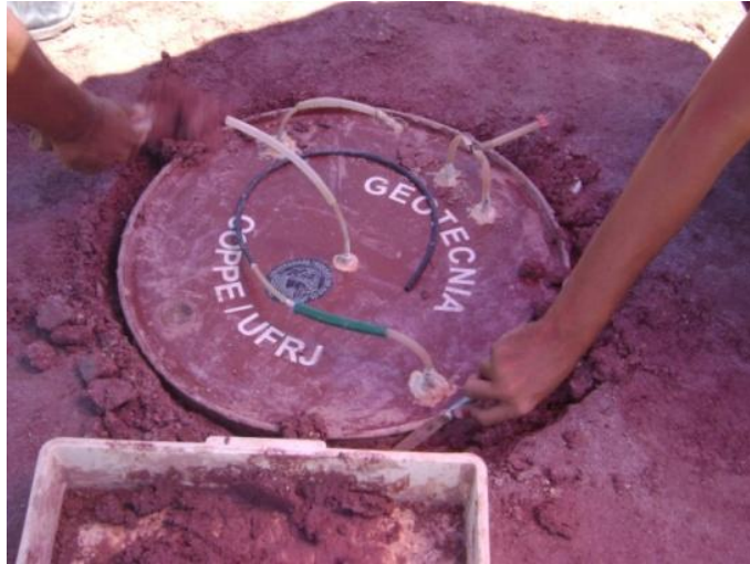
Figura 3.7: Colocação da mistura ao redor da PFLI.
