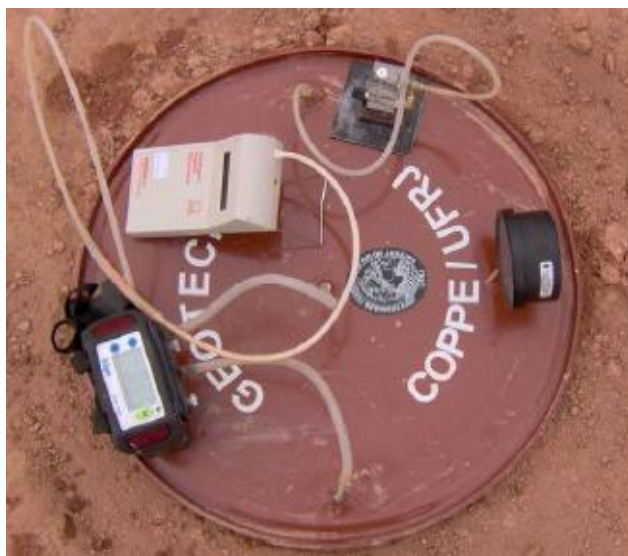
Figura 3.2: Placa de fluxo com leitura instantânea (PFLI) (GUEDES, 2007).
