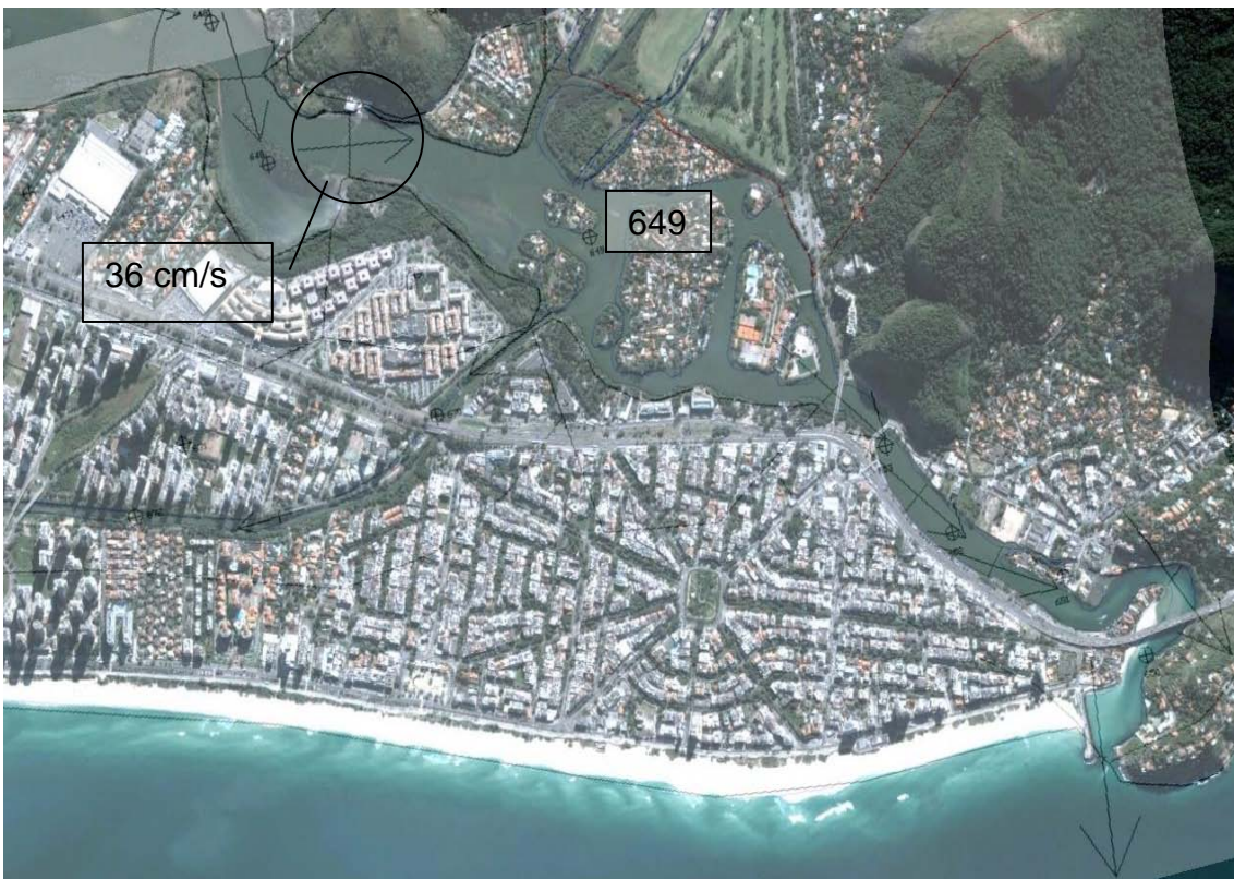
Figura 6.8 - Velocidades máximas de escoamento no canal da Barra e início do canal de Marapendi em tempo seco após dragagens.
