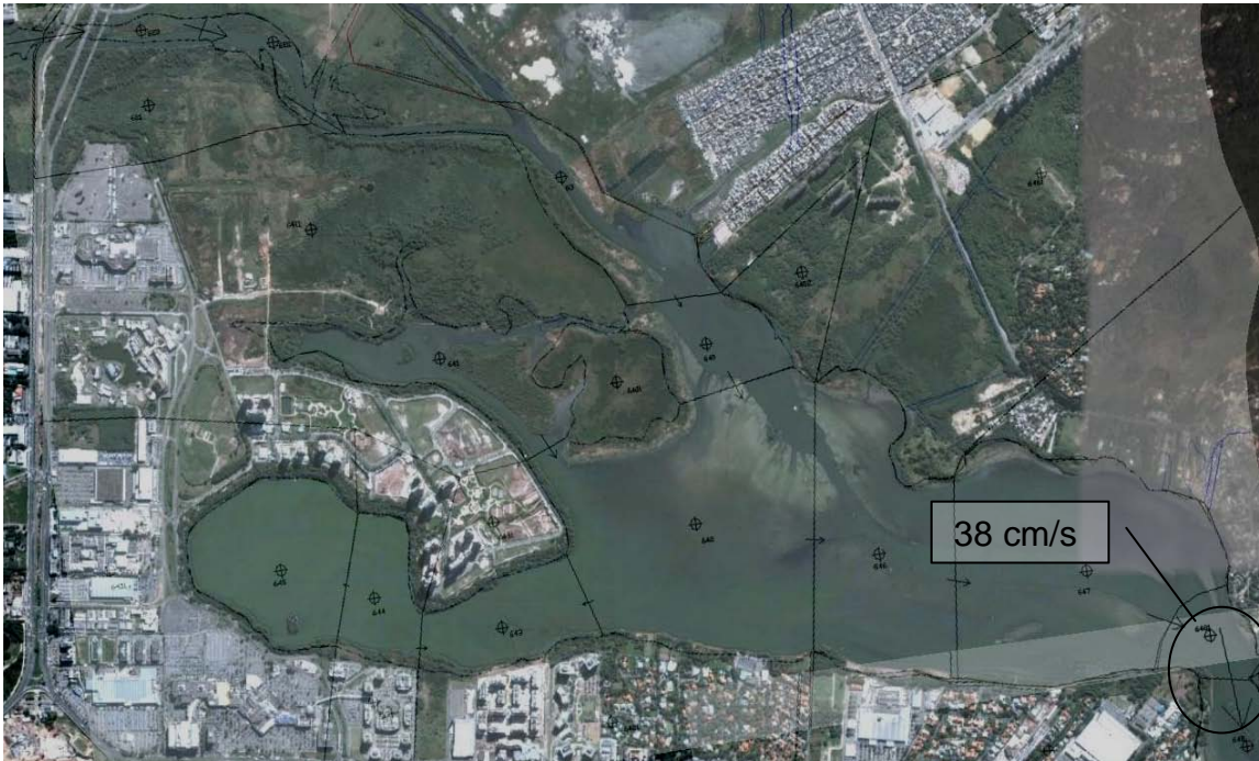
Figura 6.6 - Velocidades máximas de escoamento entre as células na lagoa da Tijuca após dragagens dos canais, em tempo seco.
