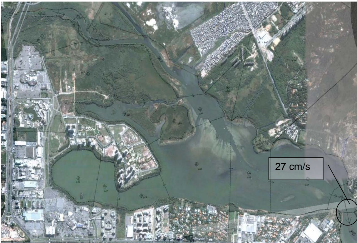
Figura 6.5: Velocidades máximas de escoamento entre as células na lagoa da Tijuca, atualmente em tempo seco.
