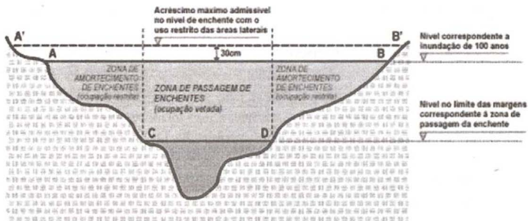
Figura 2.15 - Definição da zona de passagem de enchente (TUCCI, 2002).
