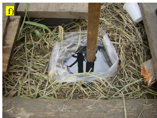
Figura 4. 4: Processo de calibrações e saturação do Piezocone
