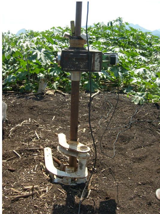
Figura 4. 18: Equipamento de palheta instalado no CM I
