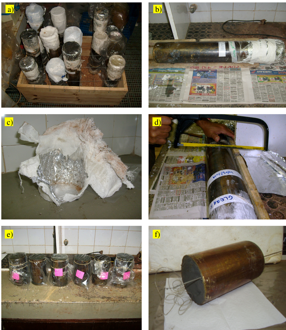
Figura 3. 14: Extração de amostras indeformadas
