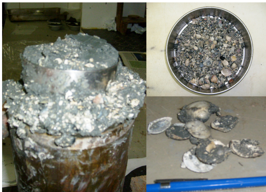
Figura 3. 9: Detalhe da camada de concha encontrada na profundidade de 4,50 m no CM II
