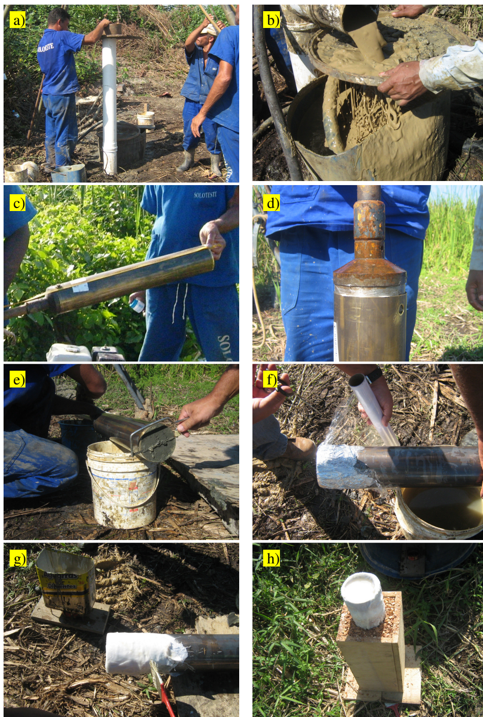
Figura 3. 13: Extração de amostras indeformadas
