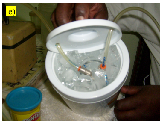
Figura 4. 4: Processo de calibrações e saturação do Piezocone
