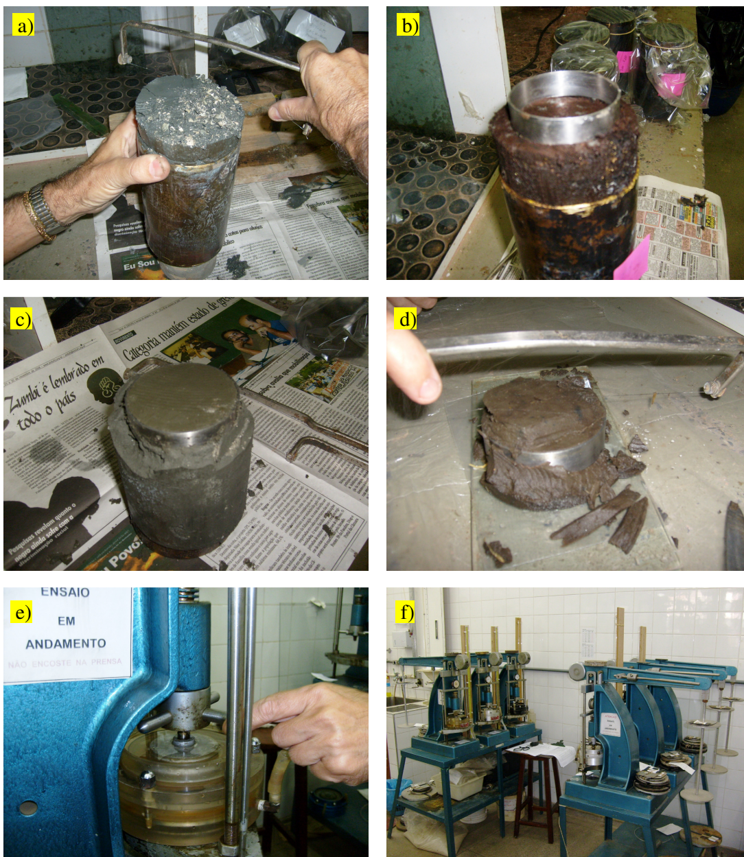
Figura 3. 15: Moldagem dos corpos de prova e ensaio de adensamento
