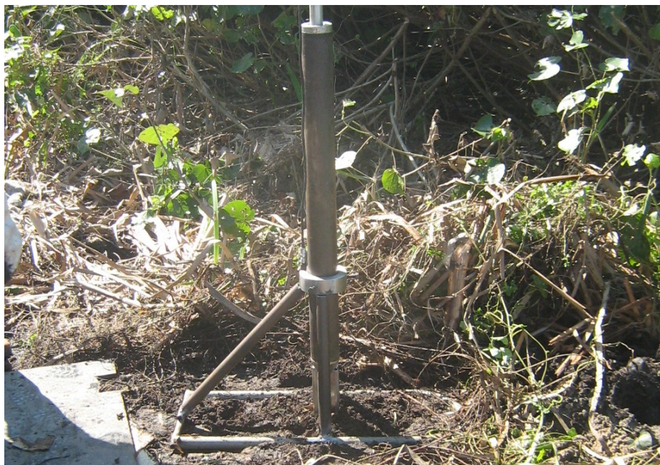
Figura 4. 21: Suporte do ensaio de palheta na profundidade de 0,50 m
