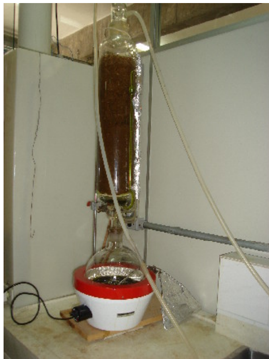
FIGURA 10 - APARELHO DE SOXHLET MODIFICADO PARA PREPARAÇÃO DOS EXTRATOS DAS CASCAS DE Celtis iguanaea
