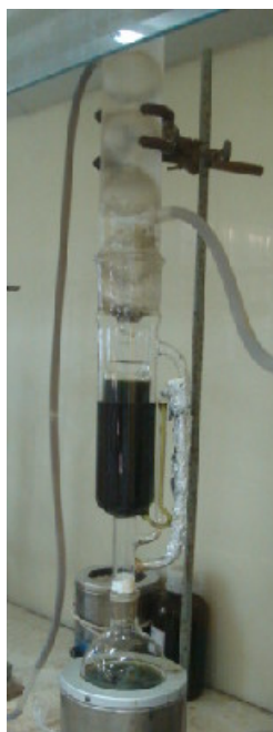
FIGURA 11 - APARELHO DE SOXHLET ADAPTADO PARA O PARTICIONAMENTO LÍQUIDO-LÍQUIDO DO EXTRATO BRUTO DAS CASCAS DE Celtis iguanaea
