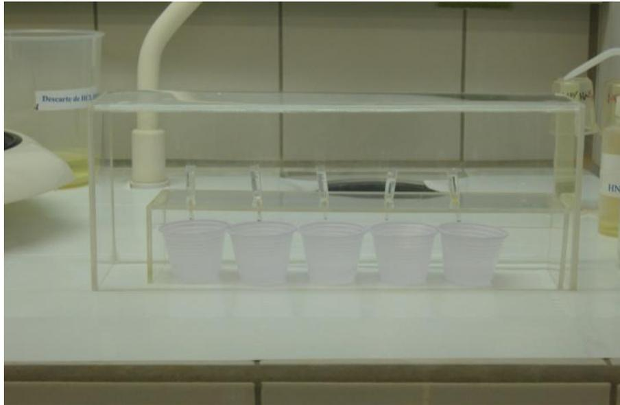
**Figura 5.7: Foto do sistema de separação: coluna, resina, suporte e coletor**
