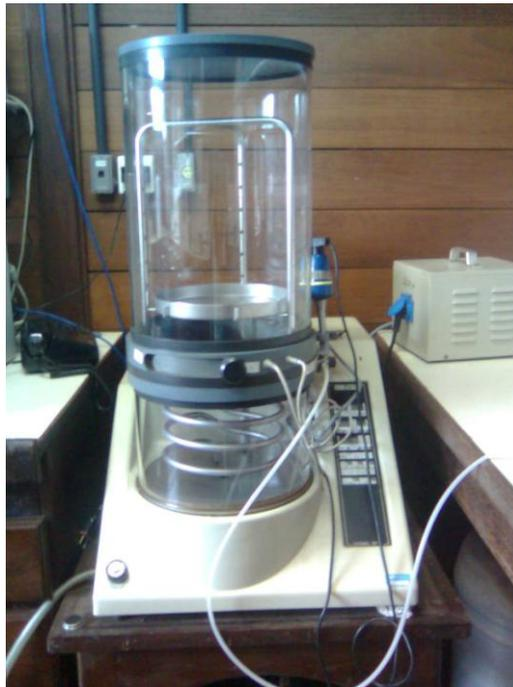
**Figura 5.4: Foto do aparelho Liofilizador Edwards**
