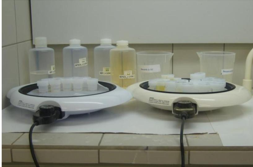
**Figura 5.5: Foto das chapas de digestão de amostras biológica e sedimento**
